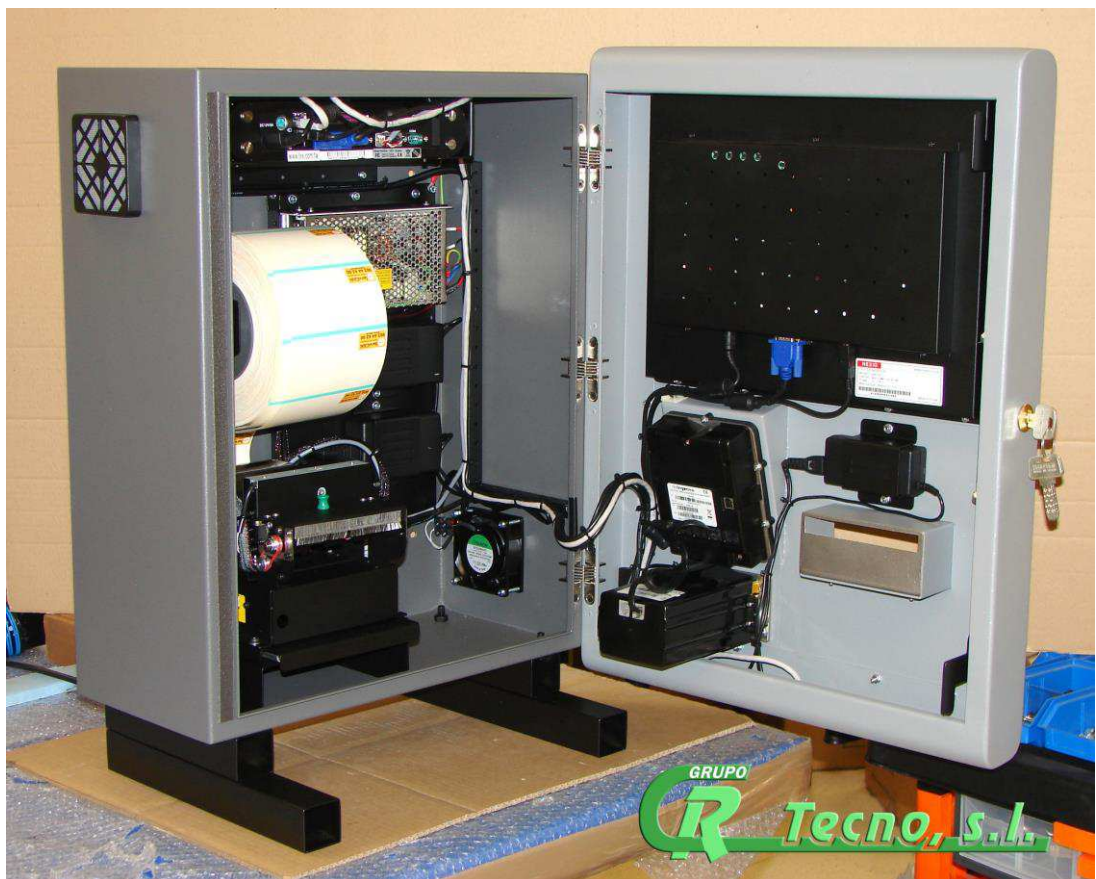
Img nº3.- Detalle de la disposición del cableado para evitar contactos indeseados con la tensión
