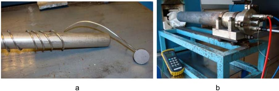
Fig. 4.50. a) Termopar tipo K; b) Tubo de acero empleado en los tratamientos térmicos 1 y 2.
