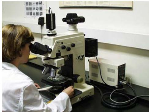
Fig. 4.9. Microscopio Metalográfico Nikon Microphot FX.
