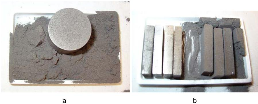
Fig. 5.100. Desmoronamiento durante el secado de piezas porosas desarrolladas por el método espaciadores: a) Probeta de compresión con 70%v Espaciador; b) Probetas de flexión con 70 %v y 55%v de espaciador.
