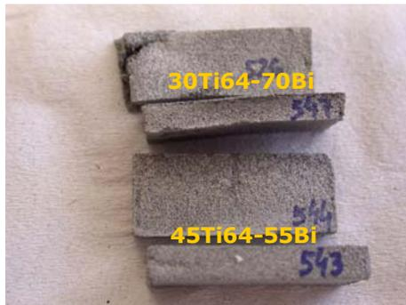
Fig. 5.99. Piezas porosas desarrolladas por el método espaciadores, con 70 %v y 55%v de bicarbonato de amonio, compactadas a 300 MPa.
