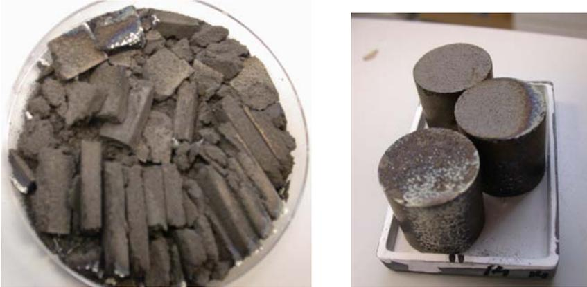
Fig. 5.101. Evaporación espontánea del bicarbonato de amonio en probetas de: a) Flexión; b) Compresión.
