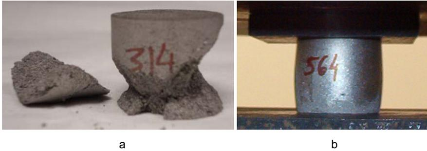
Fig. 5.118. Ensayo compresión de muestras con espaciador compactadas a 100 MPa y sinterizadas a 1300 °C, 1h: a) Frágil, probeta con 60% Ti64; b) Dúctil, probeta con 100% Ti64.
