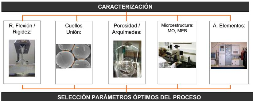
Fig. 4.24. Caracterización realizada para optimizar las propiedades de las piezas porosas desarrolladas por sinterización de microesferas.
