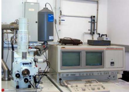
Fig. 4.10. Microscopio Electrónico de Barrido JEOL JSM6300.
