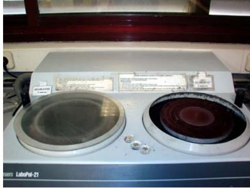
Fig. 4.8. Desbastadora/pulidora de discos giratorios, Struers LaboPol-21.
