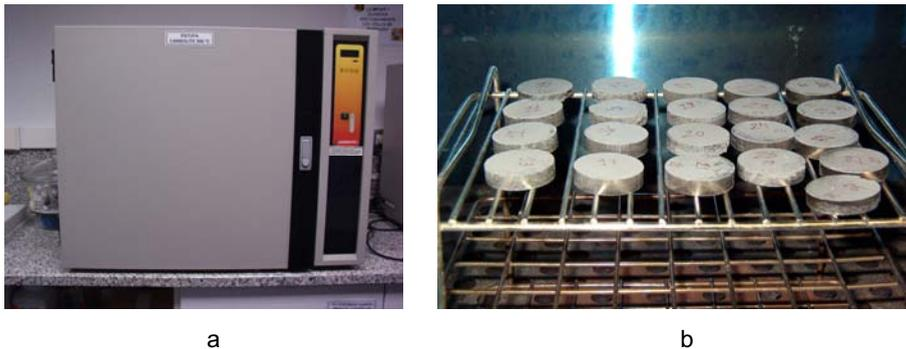
Fig. 4.29. a) Estufa Carbolite; b) Compactos en verde de TiCP3 / bicarbonato de amonio.
