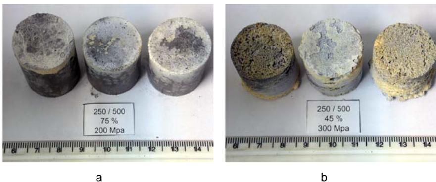
Fig. 5.103. Aspecto de las probetas de Ti64 con urea como espaciador tras su secado: a) 25%v urea, 200 MPa; a) 55%v urea, 300 MPa.
