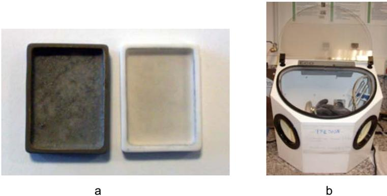
Fig. 4.22. a) Moldes de Al<sub>2</sub>O<sub>3</sub>: Izquierda, tras la sinterización; derecha, tras limpiar con chorro de arena; b) Arenadora Eco Plus de Dentalfarm.
