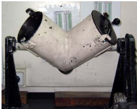
Fig. 4.31. Mezclador en V.
