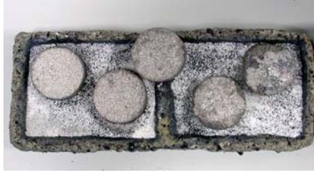
Fig. 4.30. Sinterización de TiCP3 poroso sobre crisol de gres.
