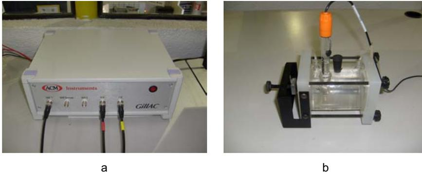
Fig. 4.53. a) Potenciostato/Galvanostato *Gill AC*; b) Celda plana PAR K0235.
