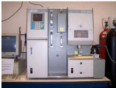
Fig. 4.43. Analizador elemental de C y S, modelo CS200 de Leco.
