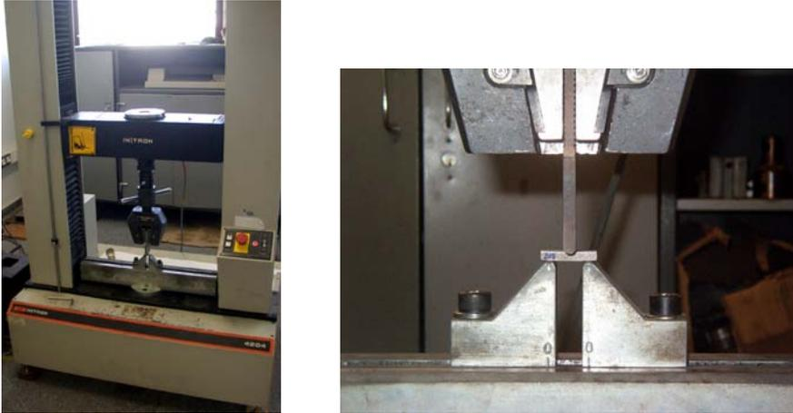
Fig. 4.38. Prensa Universal de Ensayos INSTRON 4204.
