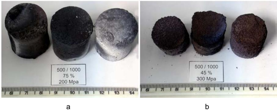
Fig. 5.104. Aspecto de las probetas de Ti64 con urea como espaciador tras su sinterizado: a) 25%v urea, 200 MPa; a) 55%v urea, 300 MPa.
