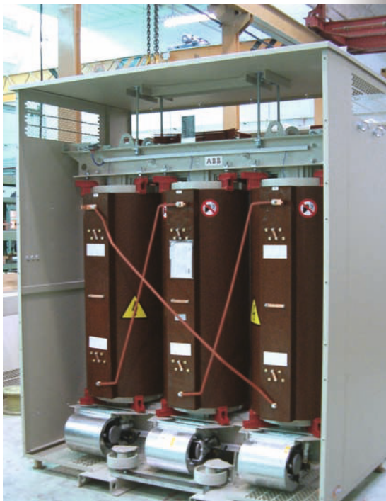
Ventiladores de refrigeración AN/AF (aire natural/aire forzado) transformadores refrigerados por ventilador diseñados para canalizar el flujo de aire en los canales de refrigeración. Aumento de capacidad de hasta el 50 %.
