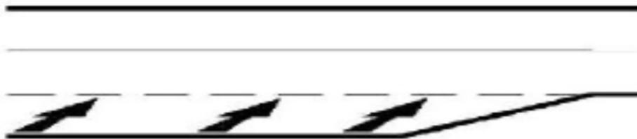
**Figura 8.** Detalle sección para carreteras 2+1 con eliminación del carril para vehículos lentos. Fuente: Radimsky, M., (2014).
