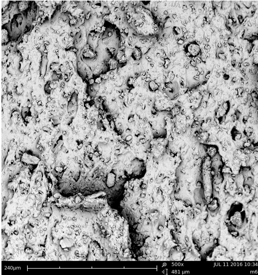
Figura 64.- Micrografía de la morfología de la probeta cobre/cobre a 30 mm y 10 segundos y el adhesivo. (500 aumentos)
