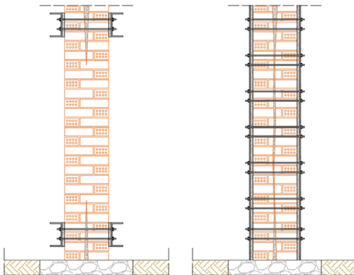
Ilustración 100: Refuerzo de pilar mediante zunchado con perfiles UPN y pletinas. Fuente propia.
