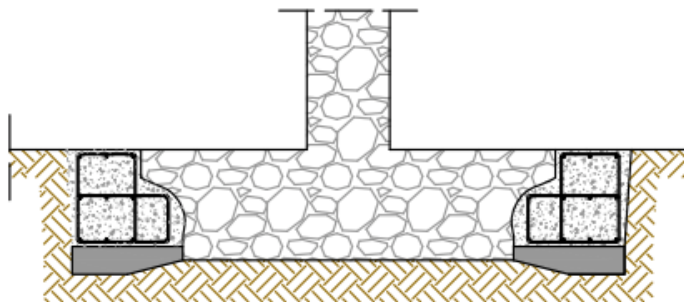
Ilustración 80: Sección zapata aislada. Refuerzo 3. Fuente propia.
