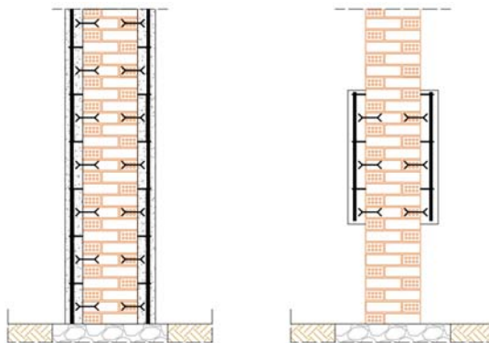
Ilustración 96: Refuerzo de pilar mediante encamisado de hormigón. Fuente propia.
