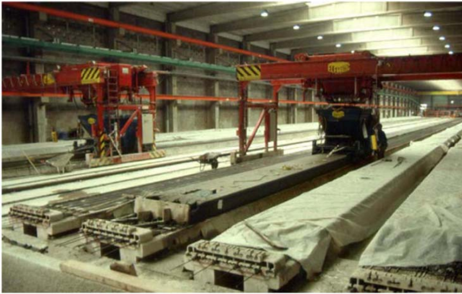
Fig. 3.13 Curado con recubrimiento de lámina plástica
