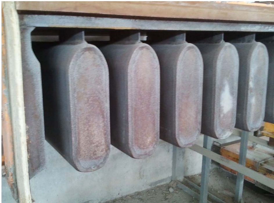
Fig. 3.11 Molde afinador de Placa Alveolar para máquina de vibro-compresión (Imagen cedida por HERMO, S.L)
