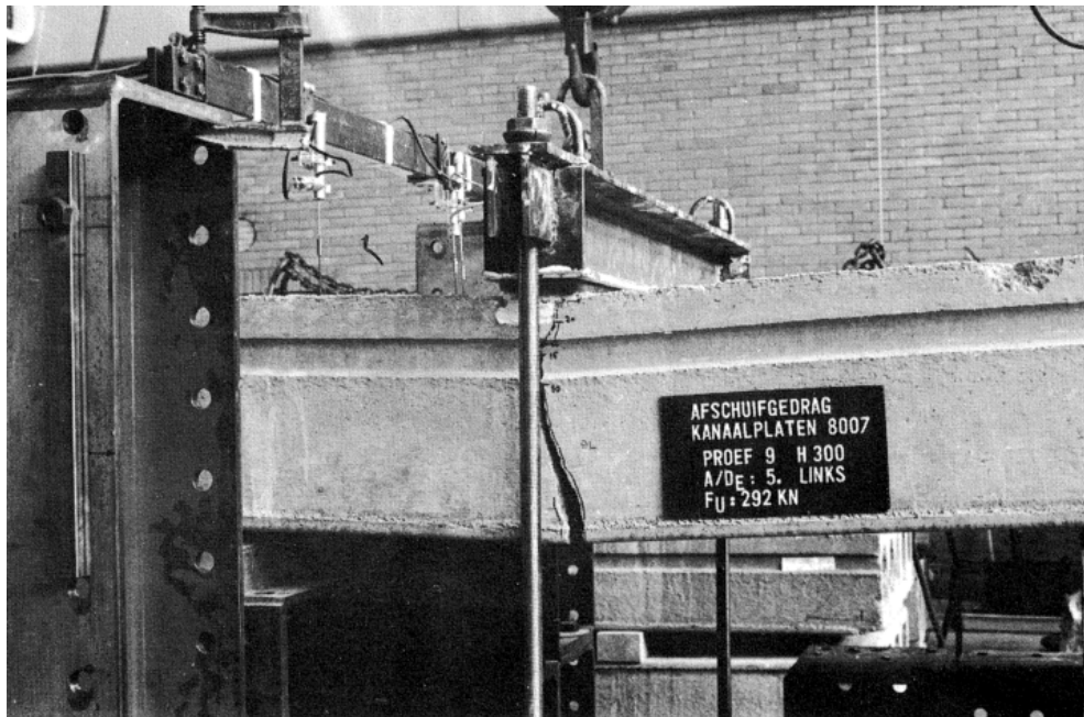
Fig. 5.6 Fallo por anclaje. (Walraven and Mercx 1983)
