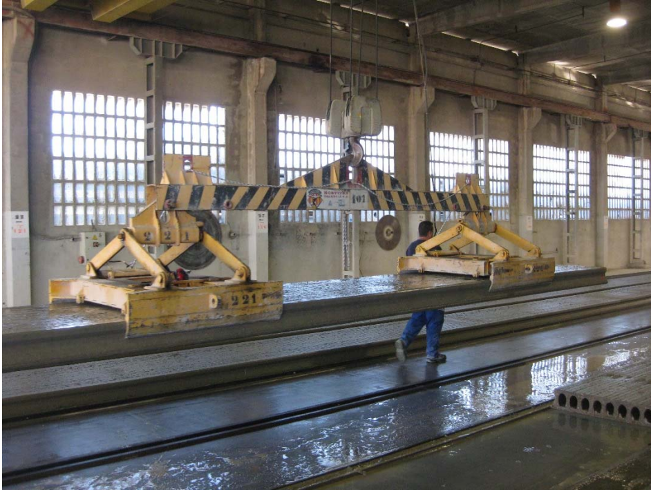
Fig. 3.15 Equipo para la retirada de pista (Imagen cedida por HORVITEN VALENCIA, S.A)
