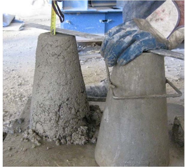
Fig. 4.3 Ensayo Cono de Abrahms. Imagen cedida por HORVITEN VALENCIA, S.A
