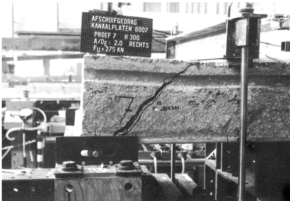
Fig. 5.7 Fallo por cortante en región no fisurada. (Shear Tensión failure) (Walraven and Mercx 1983)
