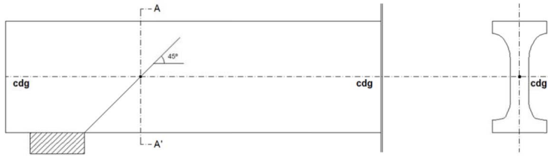
Fig. 5.27 Sección de comprobación a cortante, según EHE-08.
