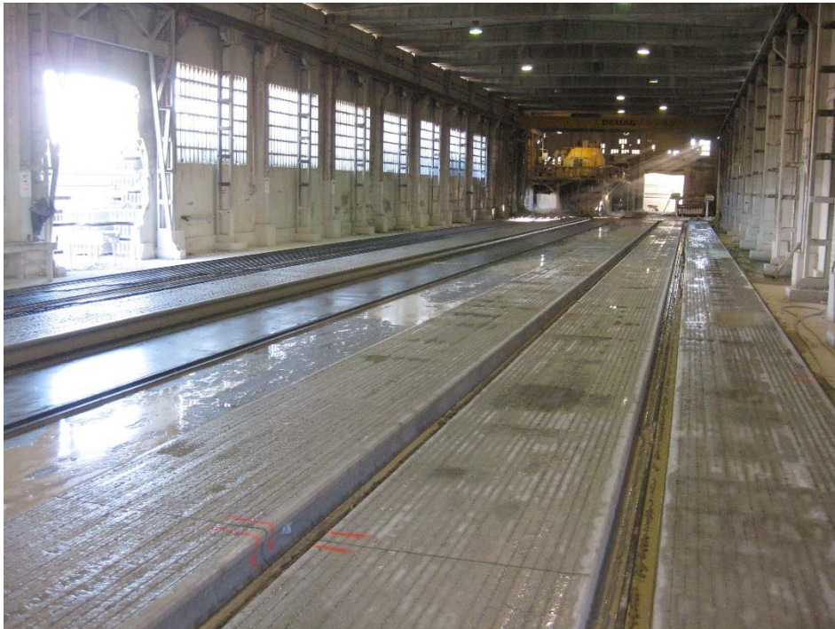
Fig. 3.4 Pista de fabricación de placas alveolares (Imagen cedida por HORVITEN VALENCIA, S.A)
