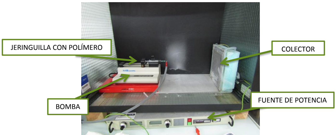
Ilustración 33. Máquina de electrohilatura a escala de laboratorio.
