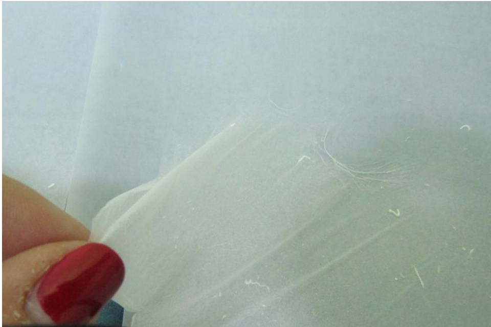
Ilustración 27. Momento de separación del velo del sustrato colector.
