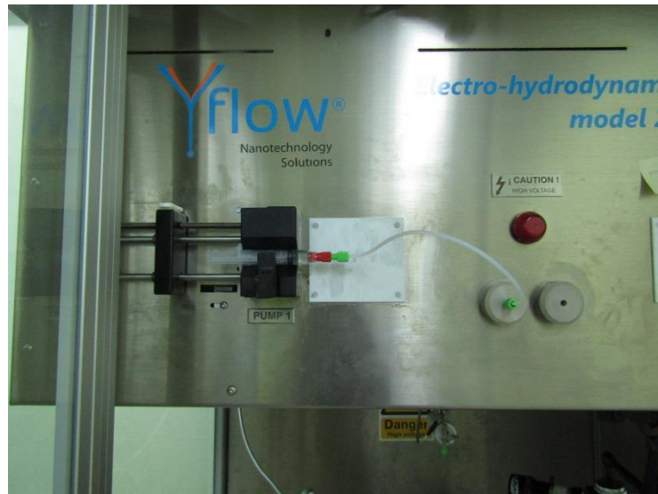
Ilustración 22. Colocación de la jeringuilla, bomba y tubo.
