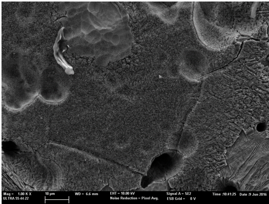
Figura 58: Superficie de Ti-21Nb tras anodizado a 25 V-1 hora
