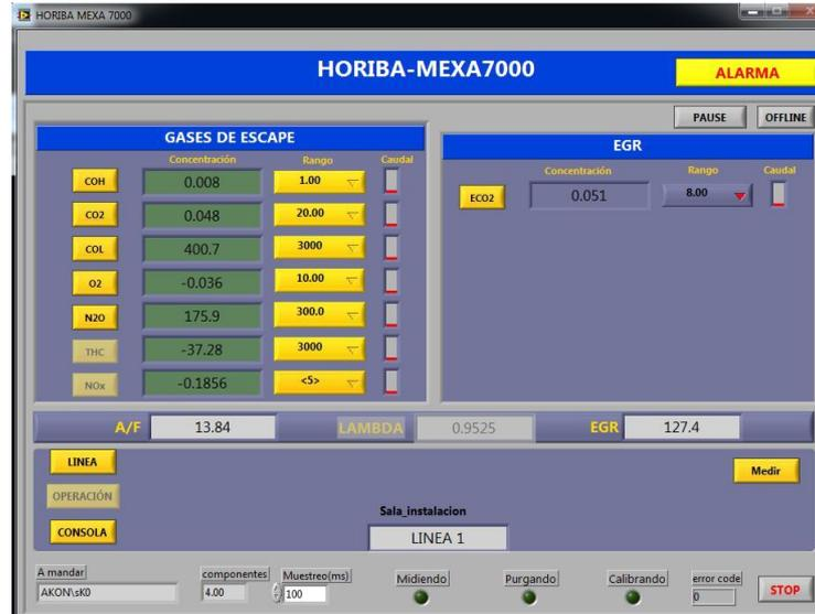
Figura. 15: Medición de emisiones de los gases de escape.
