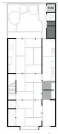
Fig. 13 Elaboración de autor. Machiya tipo. Énfasis en el toriniwa , ofuro y kura .
