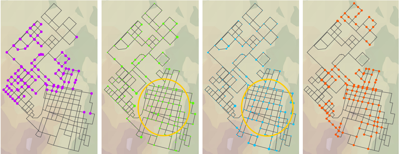
Figura 44: Los puntos morados son los asociados a aquellos grupos con coeficientes de descarga cuya media es más alta en relación a la del resto. Los puntos verdes tienen un tamaño proporcional a la longitud ponderada de tubería y los azules al número de acometidas, ambos valores estimados para el clústering de coeficientes de descarga. La zona con un número de acometidas y longitud ponderada de tubería en media alto está rodeada por una circunferencia. En la figura de la izquierda se resaltan los nudos en naranja que forman parte de clústeres con intervalos intercuartílicos menores a 0.05.
