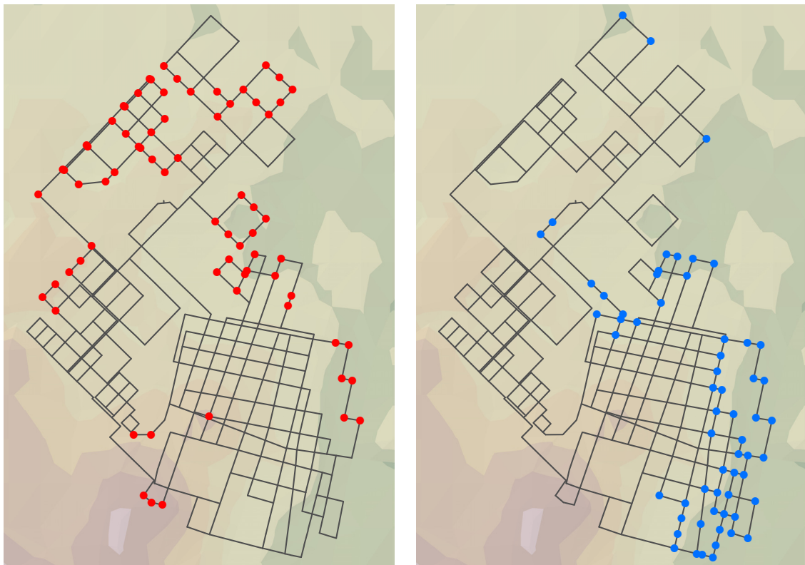
Figura 48: Se encuentran resaltados, en la figura de la izquierda, los puntos en los que se dan presiones mínimas por debajo de 5 mca y, en la de la derecha, los de presión máxima por encima de 20 mca.
