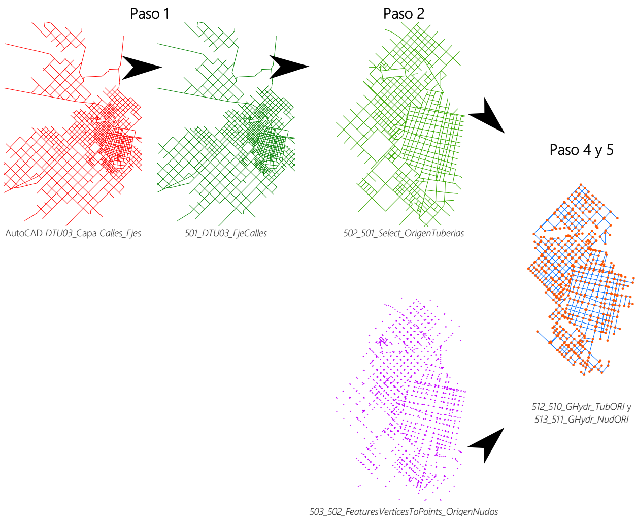
Figura 13: Diagrama de flujo para la obtención de las capas 512_510_GHydr_TubORI y 513_511_GHydr_NudORI.
