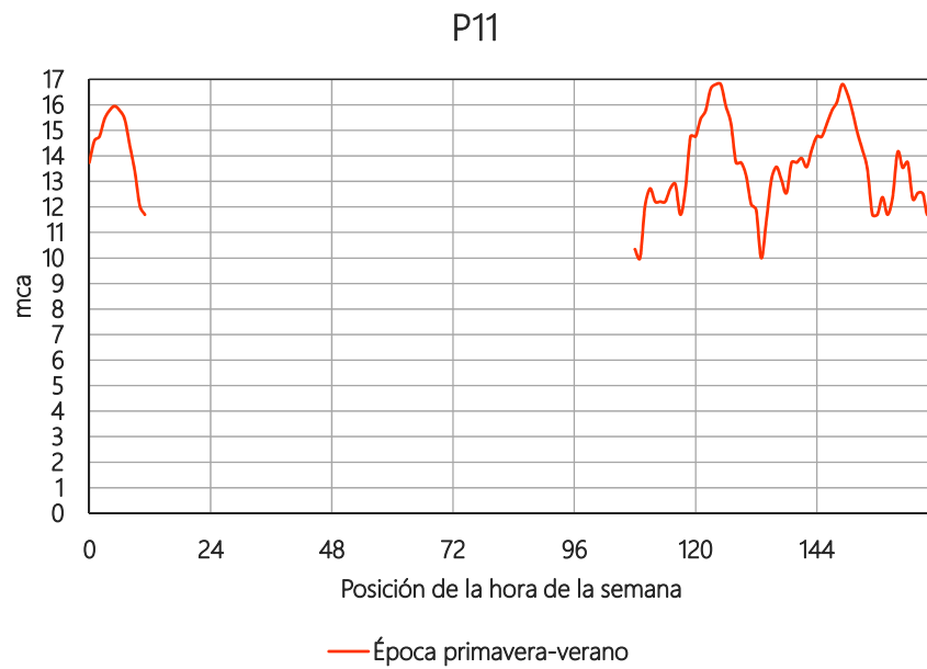
Figura A11: Registro de presiones para la época primavera-verano asociado a la medición P11, ubicada en el domicilio con dirección Yrigoyene/Parana y S. Oriz. El medidor se instaló en una acometida conectada directamente a una tubería de distribución de diámetro 175 mm.
