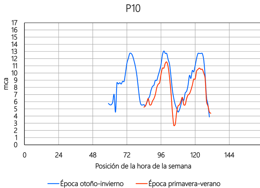
Figura A10: Registro de presiones para la época primavera-verano asociado a la medición P10, ubicada en el domicilio con dirección Ruta 12 y Victoria. El medidor se instaló en una acometida conectada directamente a una tubería de distribución de diámetro 63 mm.
