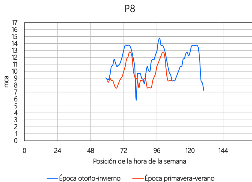
Figura A8: Registro de presiones para la época primavera-verano asociado a la medición P8, ubicada en el domicilio con dirección Avda. Marchini 1582. El medidor se instaló en una acometida conectada directamente a una tubería de distribución de diámetro 200 mm.
