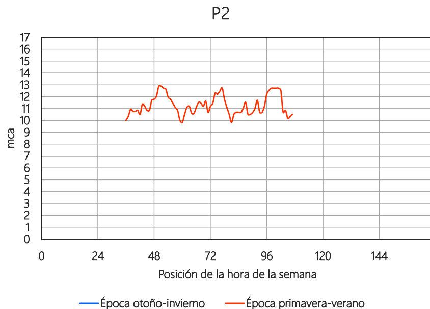
Figura A2: Registro de presiones para la época primavera-verano asociado a la medición P2, ubicada en el domicilio con dirección Avda. Marchini y Bv. Alberdi. El medidor se instaló en una acometida conectada directamente a una tubería de distribución de diámetro 160 mm.
