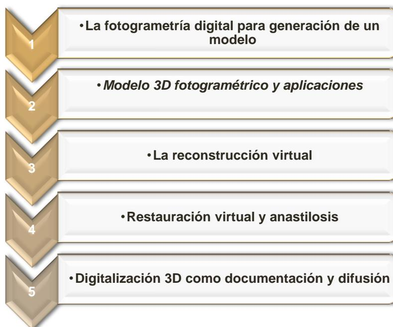
Ilustración 15. Fases para la generación de un modelo 3D fotogramétrico
