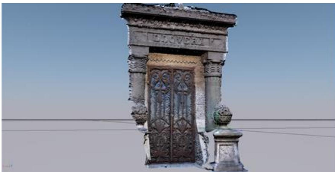
Ilustración 20. Proceso reconstrucción del pórtico, aplicación de textura.
