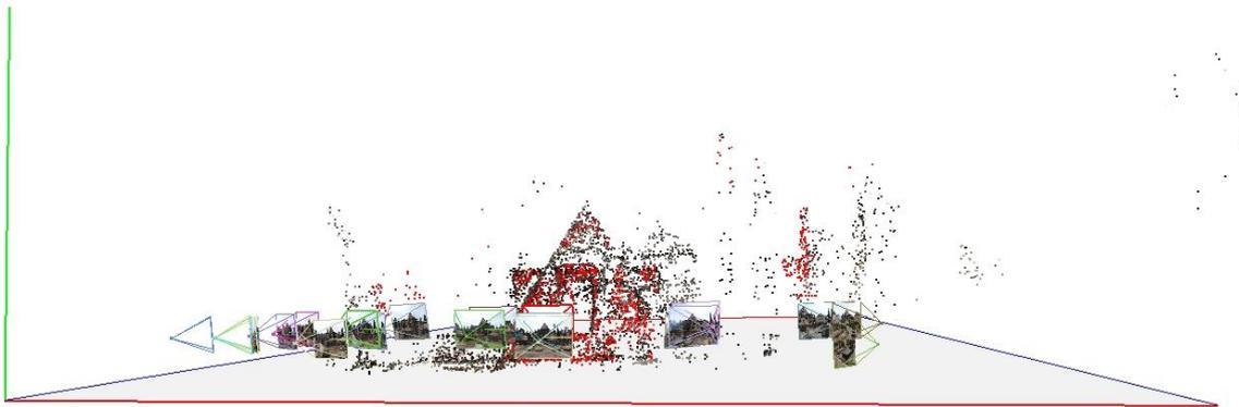
Ilustración 33. Proceso fotogramétrico. Generación de nube de puntos escasa.
