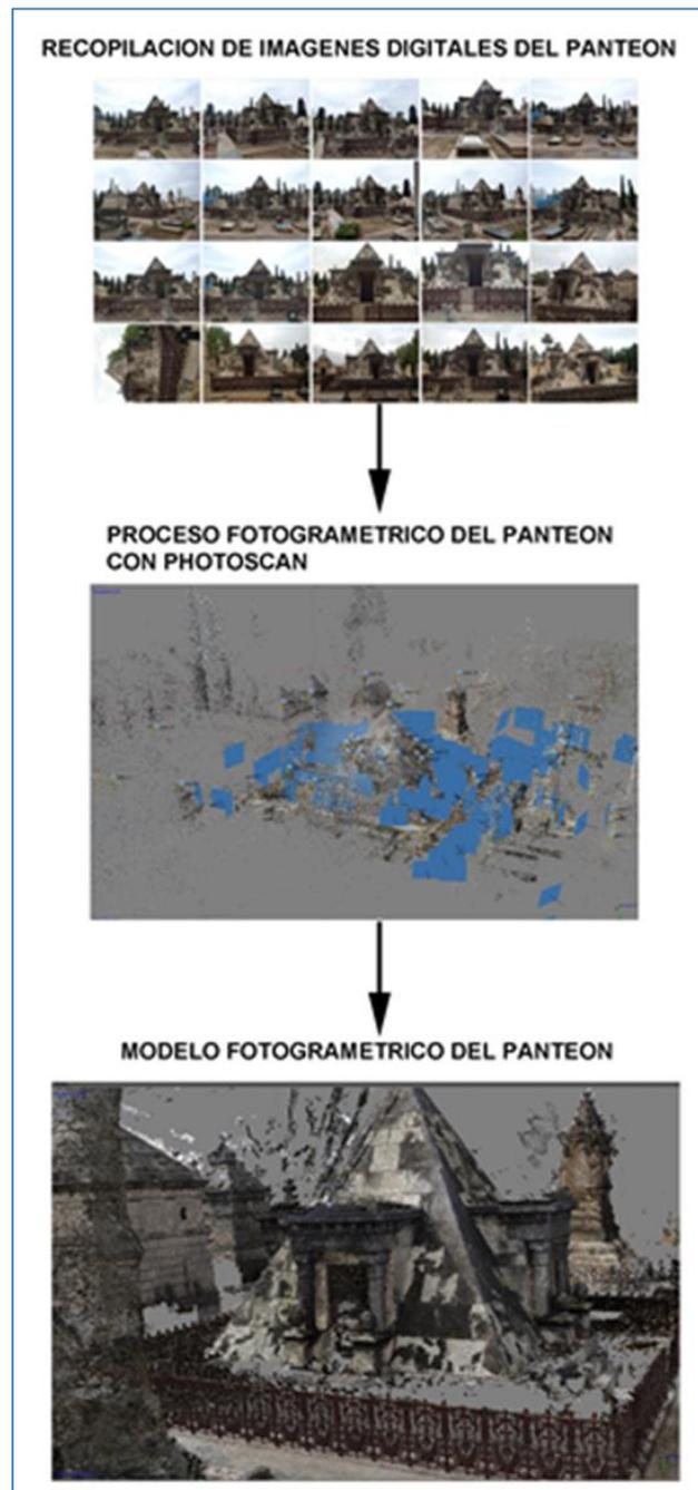
Ilustración 37. Proceso fotogramétrico a partir de imágenes digitales con Photoscan®.
