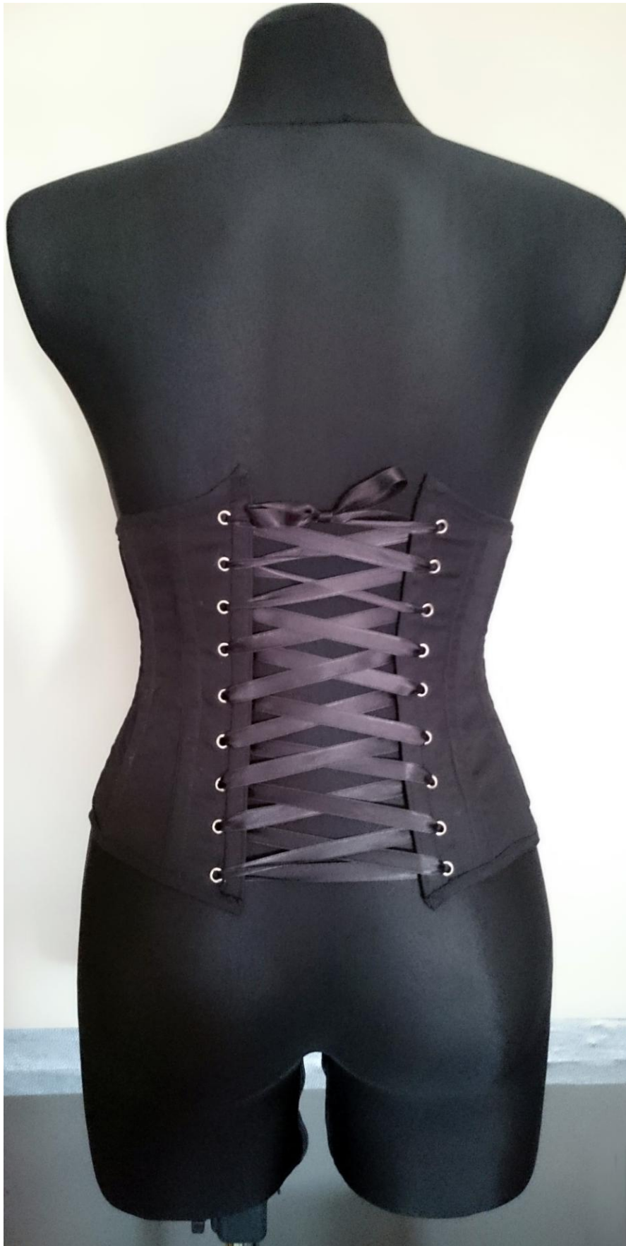
Figura 41. Corsé underbust con ballenas experimentales de material compuesto de bambú con tratamiento alcalino, carbono y basalto y matriz de bio polietileno.(Espalda)
