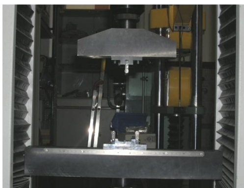
Figura 30. Equipo de tracción universal ELIB 50 con el acople de flexión.
