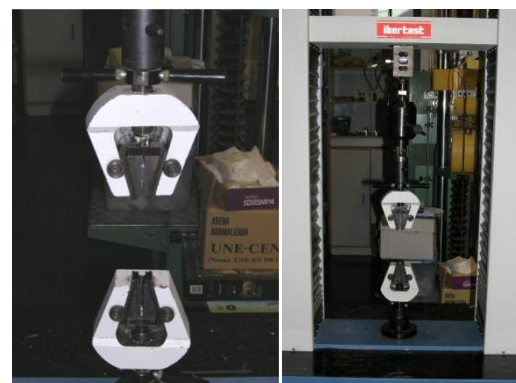
Figura 31. Equipo de tracción universal ELIB 50 con el acople de tracción.
