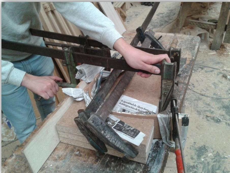
Fig. 89 Prensado mediante sargentos
