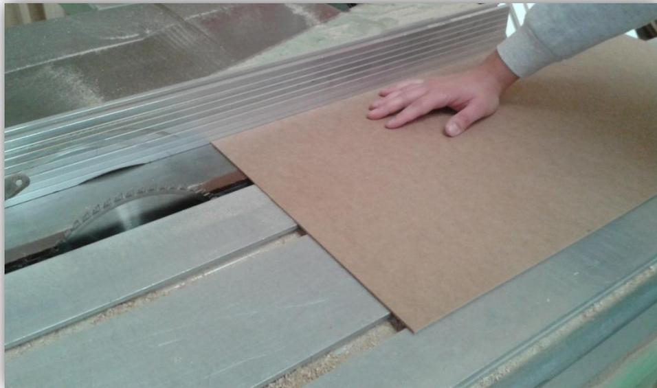
Fig. 87 Corte de tablero
