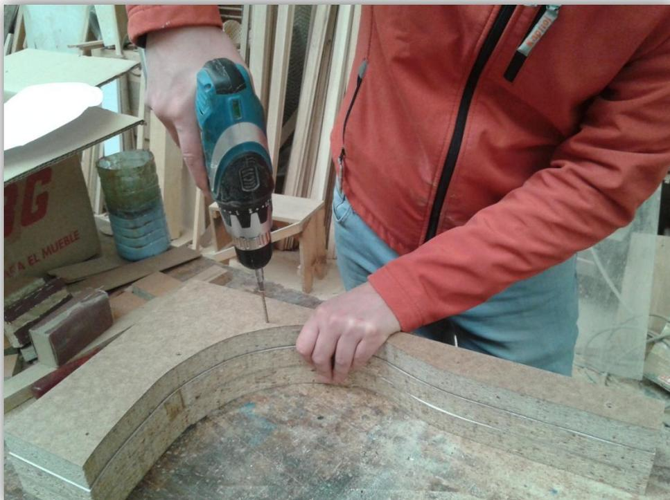
Fig. 85 Unión mediante tornillos
