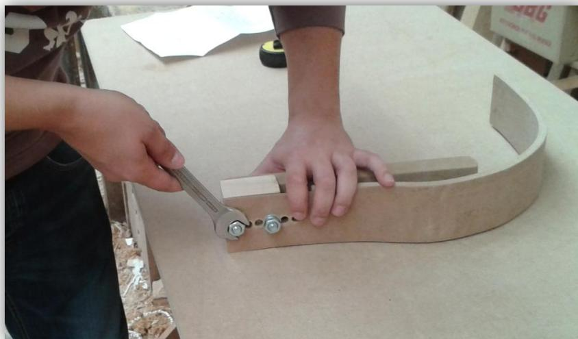
Fig. 109 Sujeción de las partes
