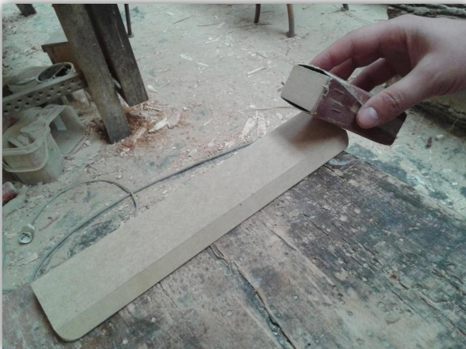
Fig. 101 Lijado de pieza
