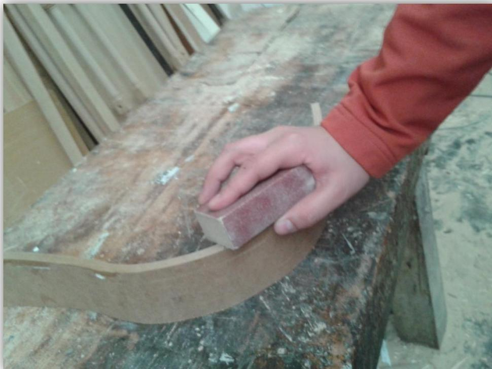
Fig. 96 Lijado de pieza
