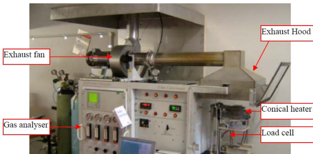
Figura 45. Cono Calorimétrico de la Universidad de Canterbury [17].
