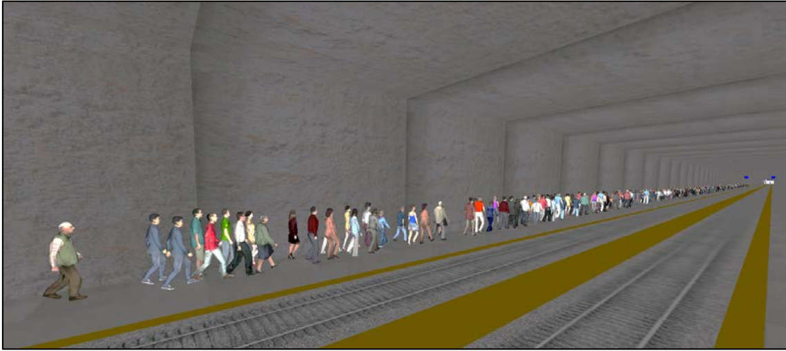
Figura 195. Ocupantes dirigiéndose a la estación a través de la acera por donde discurre la vía de evacuación.
