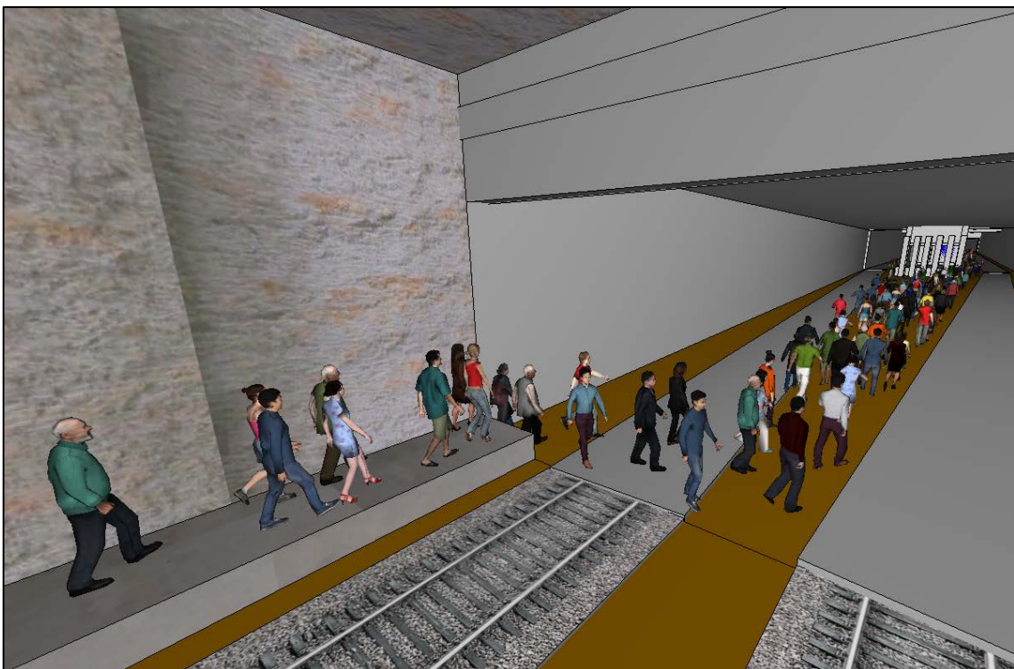
Figura 205. Encuentro entre túnel y estación. Los ocupantes bajan de la acera a la plataforma del de la vía.
