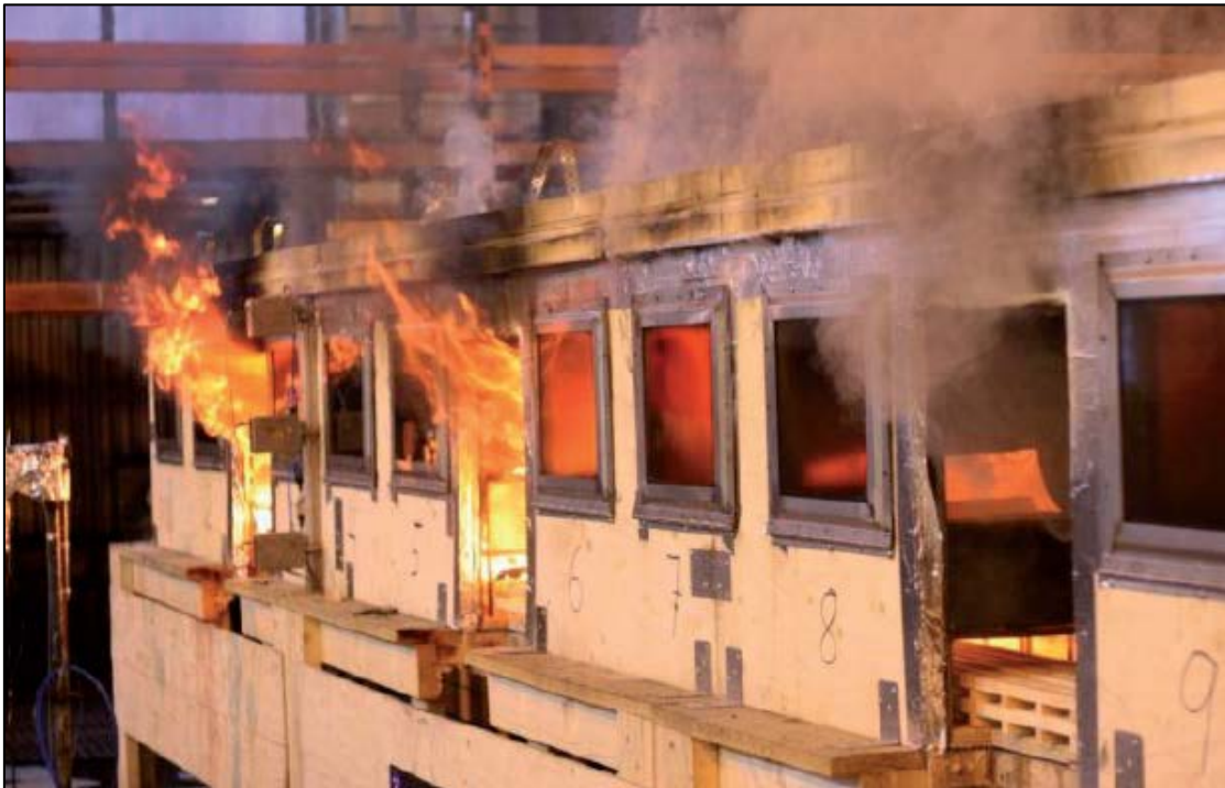
Figura 44. Incendio realizado a escala 1:3 en Metro Project [16].
