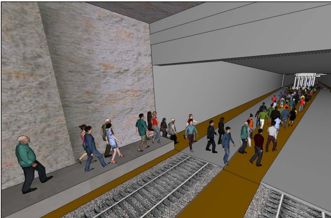
Figura 196. Encuentro entre túnel y estación. Los ocupantes bajan de la acera a la plataforma del de la vía.
