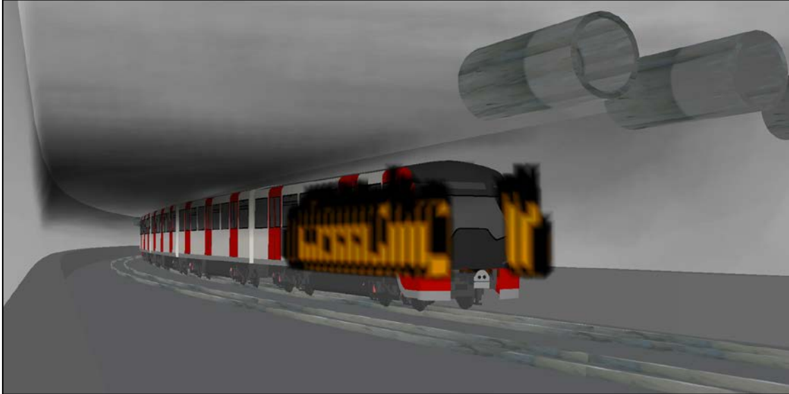
Figura 46. Incendio simulado mediante software de un modelo de campo a partir de una curva HRR
