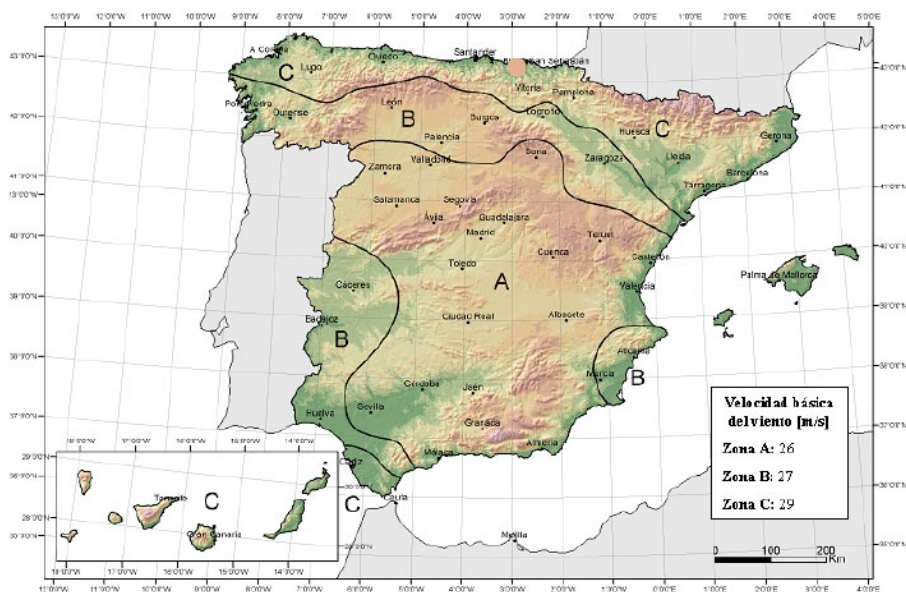
Imagen 107: Mapa de zonas para la obtención de la presión dinámica del viento.
