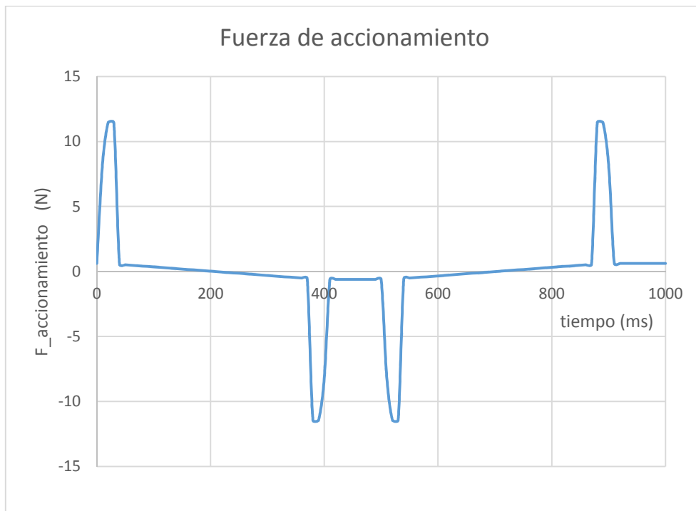
Figura 26: Variación de la fuerza de accionamiento en función del tiempo. Caso muelle tracción y cinemática onda trapezoidal.
