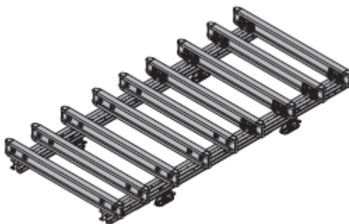
Ilustración 76 Entramado de vigas primarias y secundarias.2016.Doka
