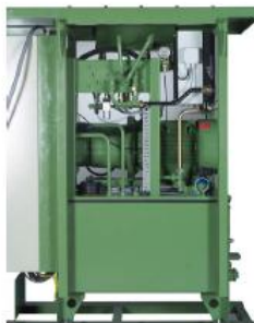
Ilustración 37 Grupo hidráulico Autotrepas.2006.Doka
