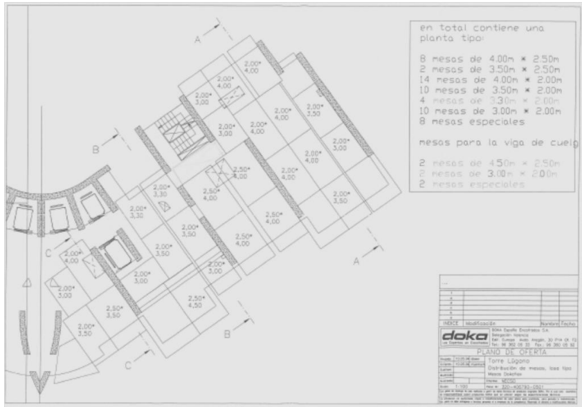
Ilustración 73 Plano Mesas de encofrado planta tipo.2005.Doka
