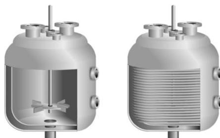
Figura 30: Reactor continuo de tanque agitado con camisa.
