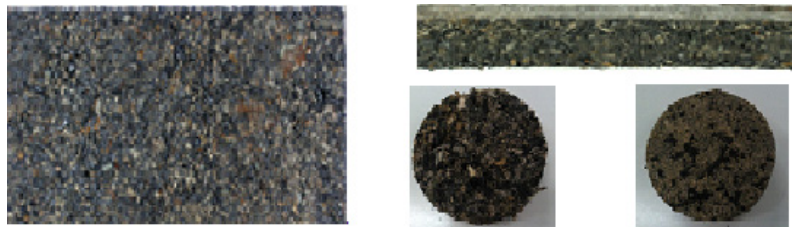
Figura 5. Fibras compactadas y muestras configuradas para el ensayo de absorción acústica.
