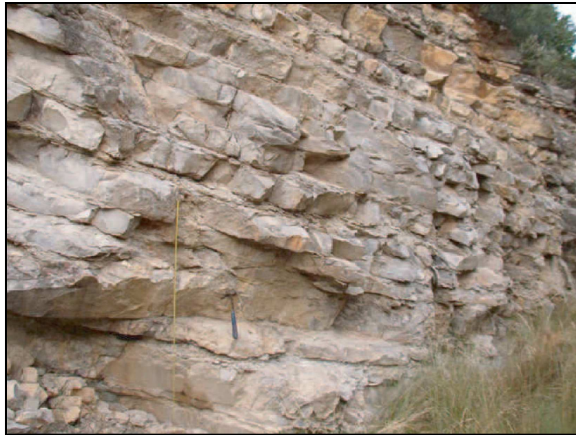
Figura 11.28: Diaclasado del macizo rocoso en el estribo derecho de la presa (Fuente: Membrillera [92]).
