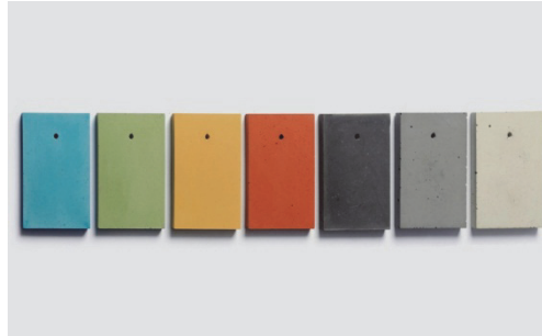
Fig. 10 – Amostras de cimento nas cores naturais e com adição de pigmentos (22 Design Studio, 2014)
