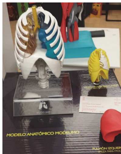
Fig. 13. Modelos impresos con tecnología FDM, estructuras encapsuladas. Estudiante dirigido: Juan Diego Erazo.
