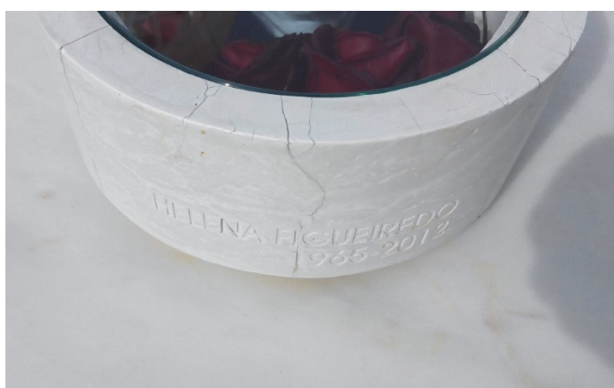
Fig. 22 - Fissuras na parede do protótipo
