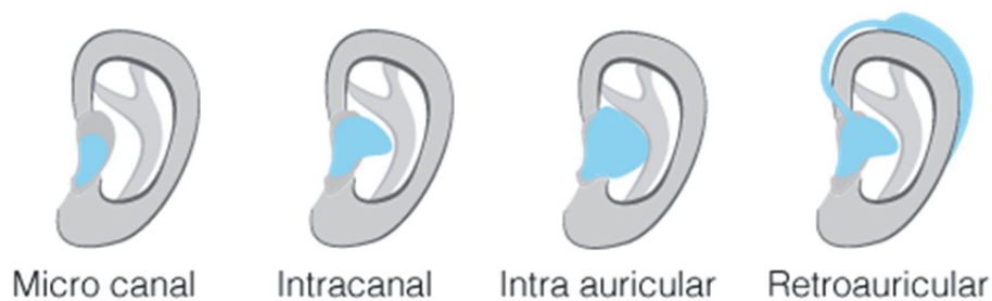
Fig. 6- Ilustração dos quatro principais modelos de aparelho auditivo
