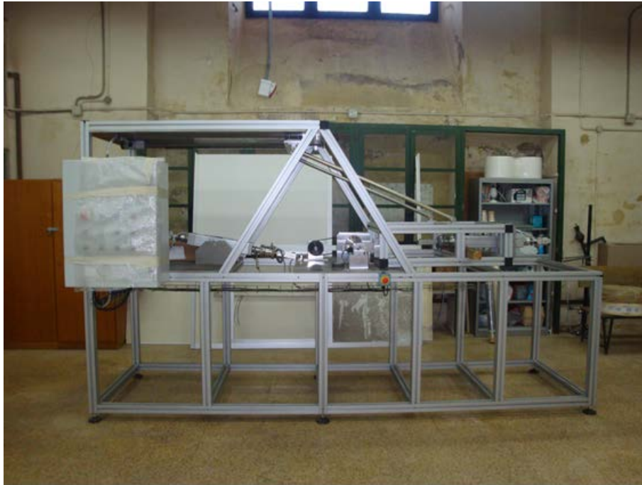
Figura 1. Simulador de deformación plástica situado en Edificio Viaducto
