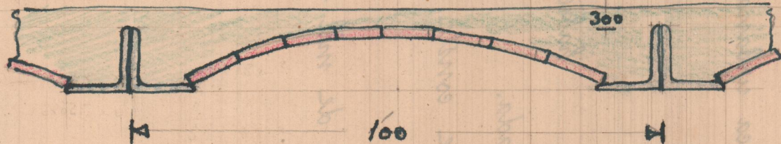
SECCION POR LAS VIGAS
