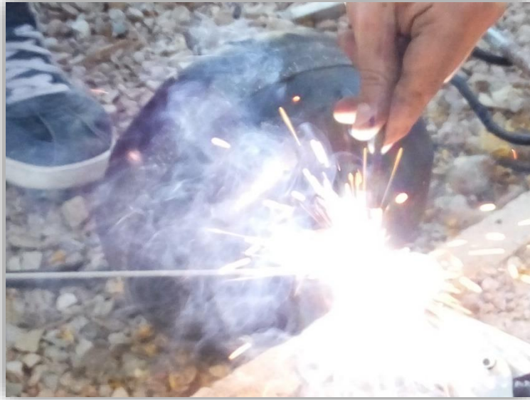
Fig. 45 Soldadura MIG varillas guardabarros.
