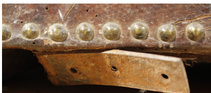
85. Detalle de la bisagra deformada.
