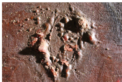
65. Detalle de exhudación de resina de un nudo.
