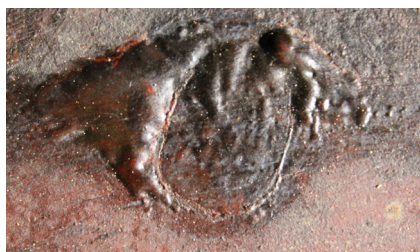
77. Detalle de abolsamiento en la película pictórica por exudación de resina de un nudo.
