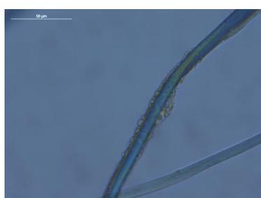
**Imagen 8.** Microfotografía de la seda de la pieza CS-CM05-02, luz polarizada 90°, X40.
