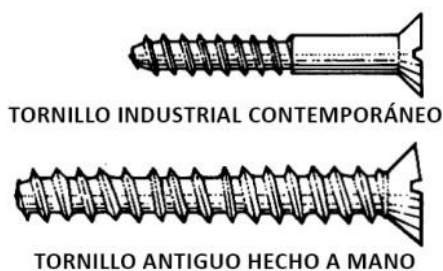
Fig. 15 Dibujo en el que se ejemplifican las diferencias entre un tornillo contemporáneo producido en serie y un tornillo antiguo fabricado manualmente.
