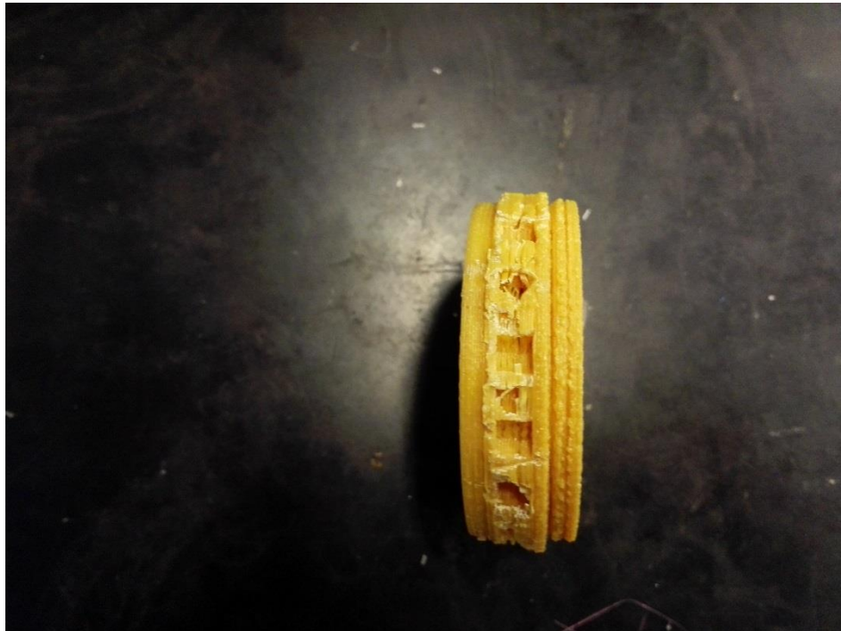
Figura 98. Intento fallido de quitar el material de soporte de la rueda
