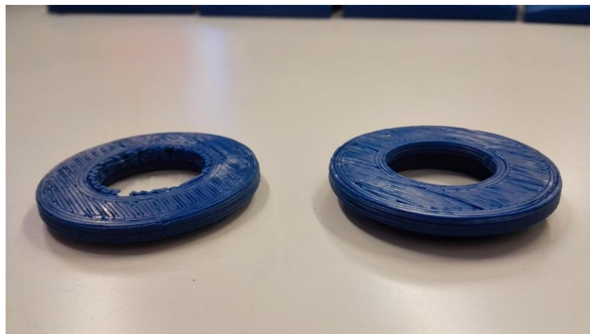
Figura 99. Rueda de arrastre dividida imprimida
