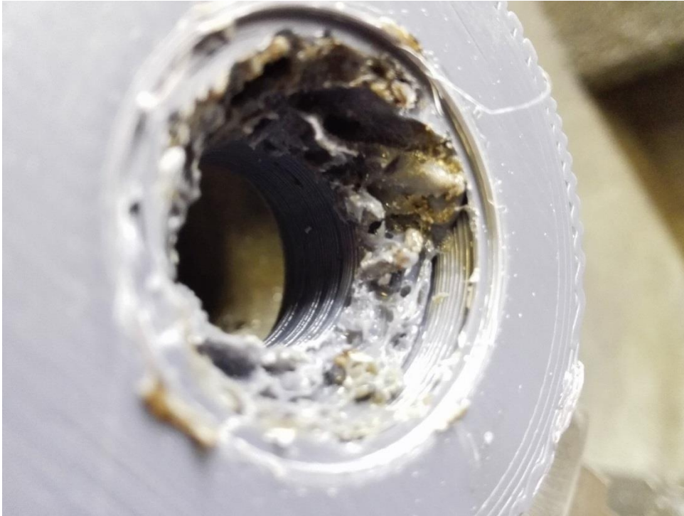
Figura 104. Intento fallido de quitar el material de soporte de la polea de desvío derritiéndolo
