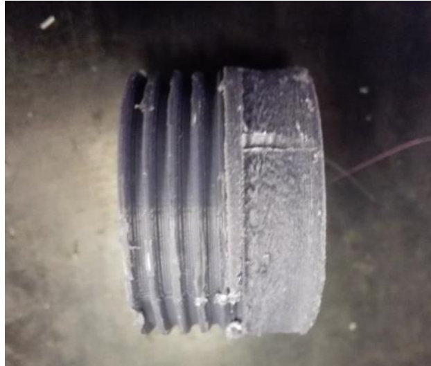
Figura 106. Intento fallido de quitar el material de soporte con el torno en la polea de desvío
