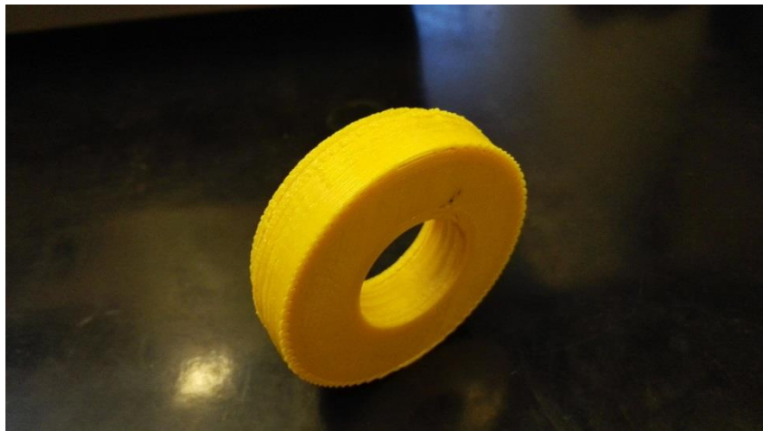
Figura 96. Resultado primera impresión de la rueda
