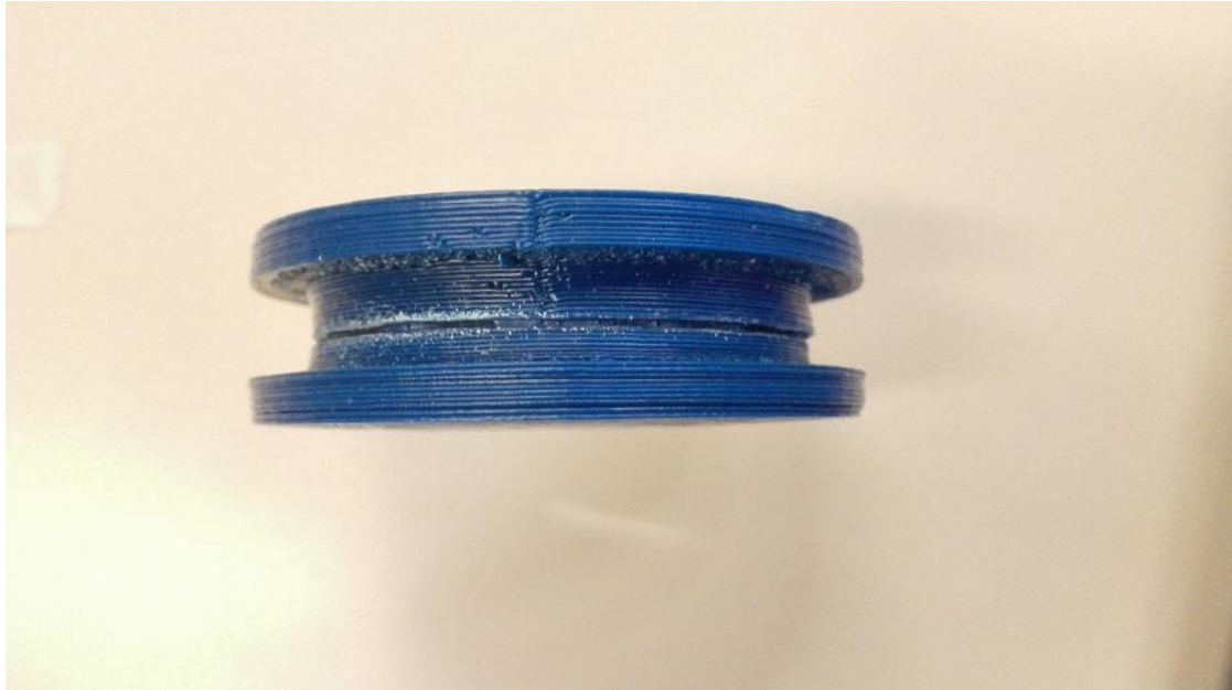
Figura 100. Partes de la rueda de arrastre pegada
