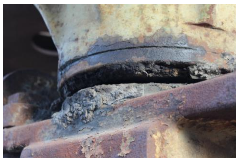
Figura 33: Detalle grasa seca del engranaje.
