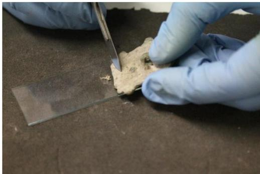
Figura 11. Proceso de extracción de muestra por raspado con bisturí para realizar prueba de carbonatos.
