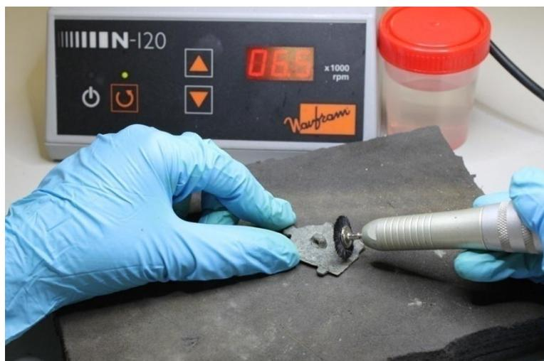
Figura 19. Limpieza del reverso con microtorno, con cepillo de cerda de plástico.
