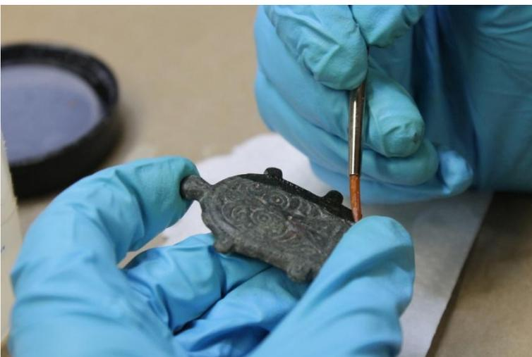
Figura 28. Protección aplicada a pincel a base de Paraloid® B-44 al 8% + BTA al 3% + acetona y alcohol en proporción 9:1.
