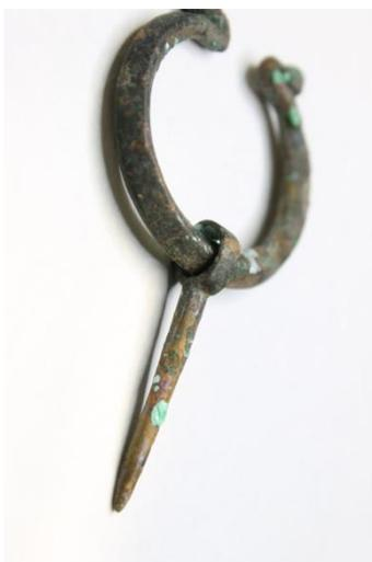
Figura 25. Ejemplo donde se muestra la salida de los cloruros activos sobre la superficie del metal.
