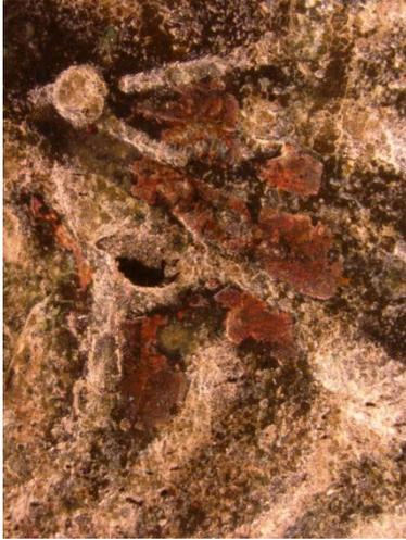
Figura 14. Macrofotografía del anverso, donde puede apreciarse depósitos de cuprita y concreciones.
