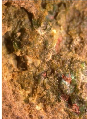
Figura 15. Macrofotografía del reverso, donde puede apreciarse depósitos de malaquita junto a algunos puntos de cuprita.
