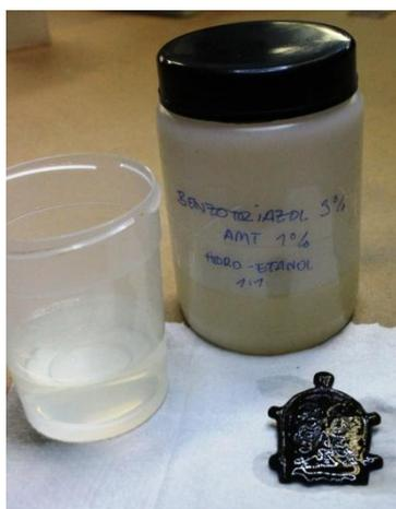
Figura 27. Pieza una vez fuera del baño esperando el secado una vez aplicada la mezcla de inhibición.
