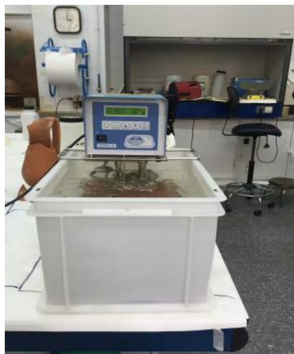
Fig. 47. Desalación con agitador magnético con temperatura.
