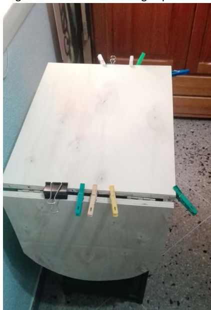
img.34. Fase encolado chapas nuevas.
