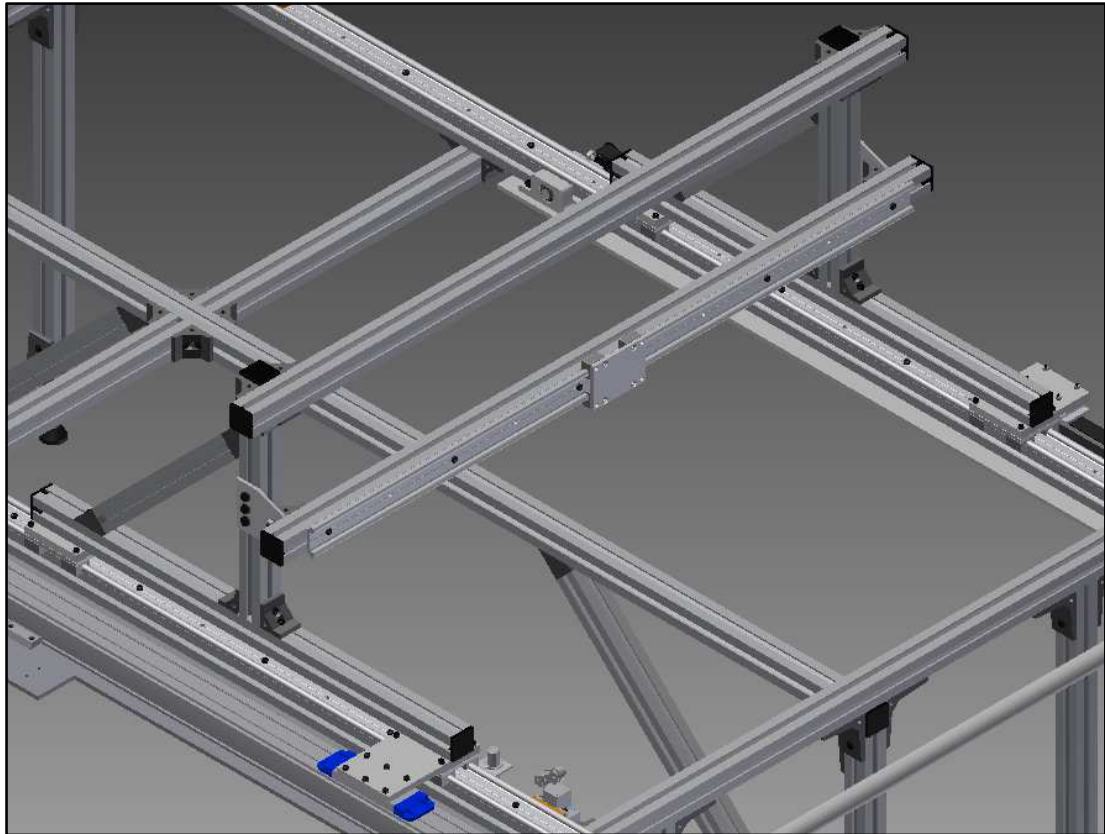
Figura 4.7 Colocación del ensamblaje del tren superior (eje Y) sobre los 4 carros, raíl lineal Igus ® a 90° y ajuste del carro drylin ® W para el actuador eléctrico del eje Z.
