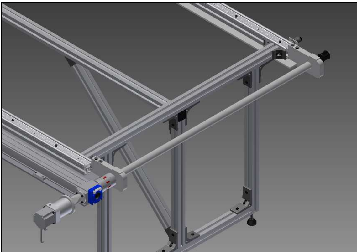
Figura 4.4 Ensamblaje del eje transmisor con polea conductora, servomotor OMRON , reductor ZF , campana inferior y acoplamientos Rotex® GS 12 y Rotex® GS 24 .
