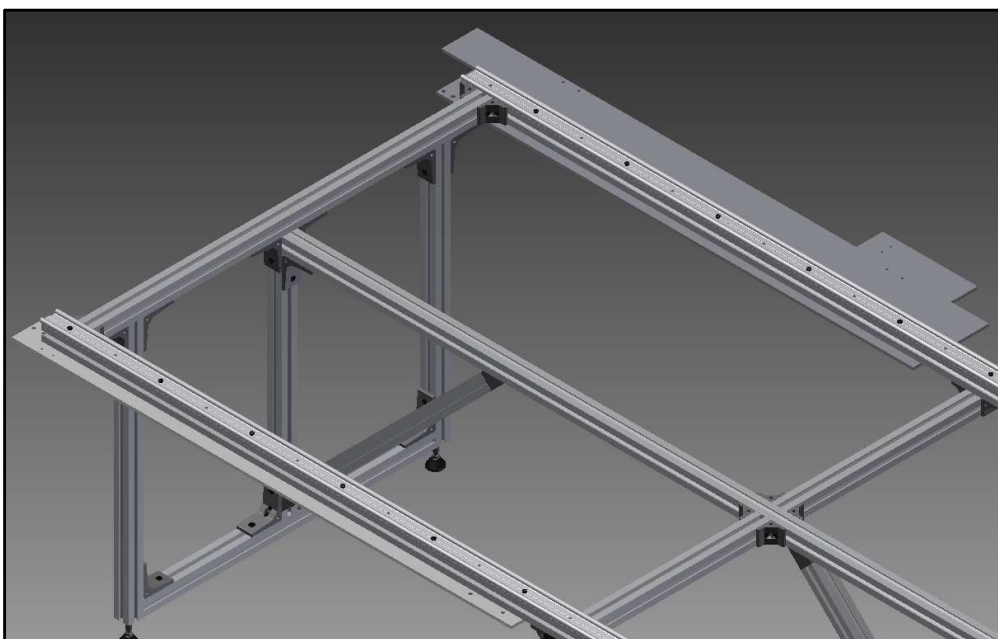
Figura 4.2 Montaje de las chapas de apoyo estructural y raíles lineales Igus ®.
