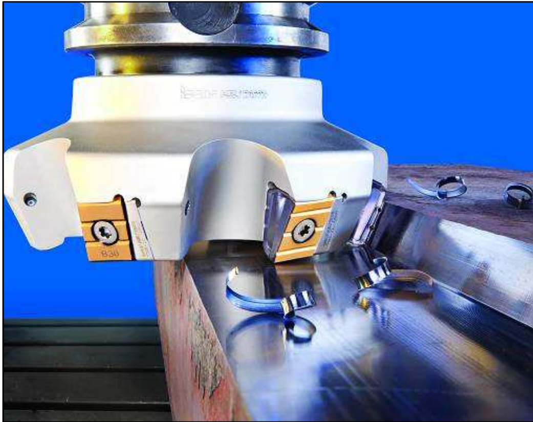
Figura 2.3 Fresa frontal de metal duro mecanizando aluminio.
