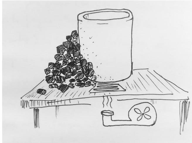
Fig. 50. JAUME ESPÍ. Esquema primer horno de fundición. 2016. Carlet (Valencia).
