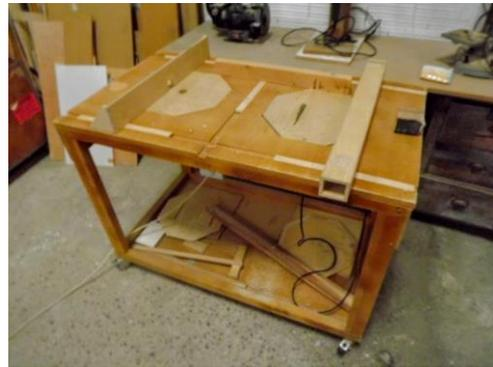
Fig. 26. Mesa de trabajo para disco de corte y tupi de Juan Francisco Jacintoles construida por el mismo bajo las instrucciones de los tutoriales y manuales de mimecanicapopular.com. 2016.
