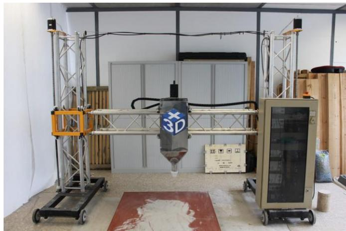
Fig. 24. Impresora cemento 3D por la empresa *Be more 3D*. 2016.
