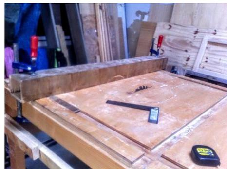
Fig. 27. Mesa de trabajo para disco de corte y tupi de Juan Ángel Meliá Romaguera construida por él mismo bajo las instrucciones de los tutoriales y manuales de mimecanicapopular.com. 2016.
