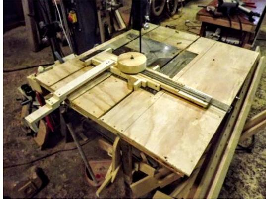
Fig. 31. XIMO ORTEGA. Sierra de banda para madera con aplicación para corte curvo. 2016.
