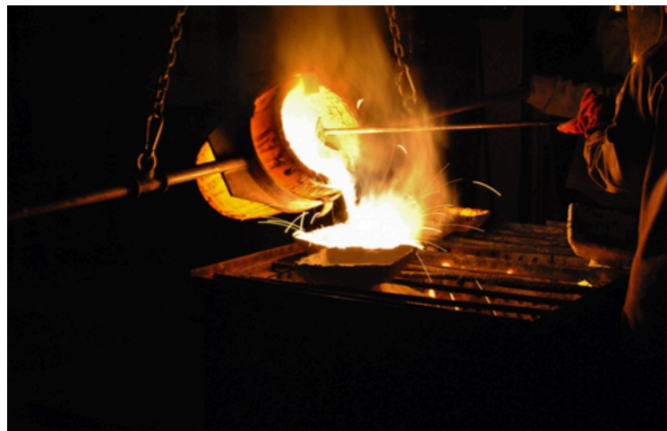
Equipo técnico realizando la colada del metal. (Fotografía: Silvia Lillo).
