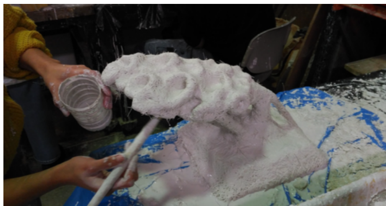
Refuerzo de fibra de vidrio con barbotina cerámica.
