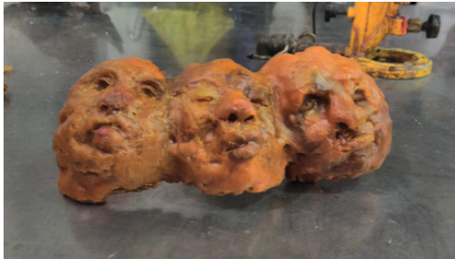
Modelado en Cera e incorporación de bebederos, copa y respiradero.
