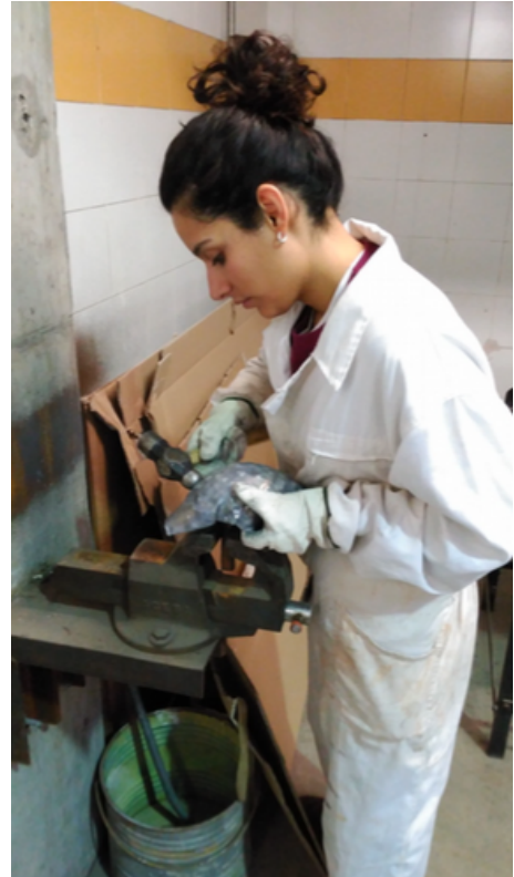
Corte a medida de las planchas y modelado a través del batido del plomo sobre esferas de metal y yunque.
