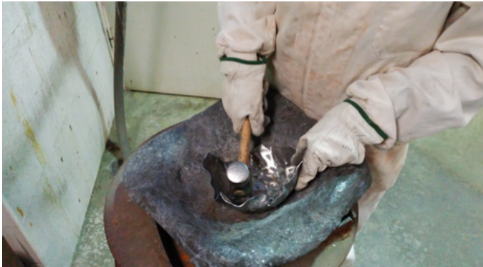
Corte a medida de las planchas y modelado a través del batido del plomo sobre esferas de metal y yunque.
