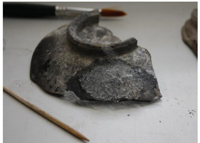
Figura 17. Prueba de limpieza química por empaco de Arbocel BC1000 con una disolución al 5% de una mezcla de EDTA bisódica y tetrasódica al 50%
