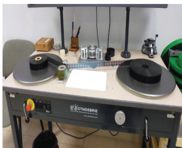
Fig.20 Mesa de rebobinado con un rollo de la película de la Coronación de la Virgen.
