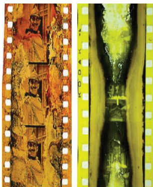
Fig.14 Descomposición Exógena de un soporte de Nitrato.
