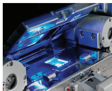
Fig.34 Escaneado de cada fotograma con la máquina "Arriscan".
