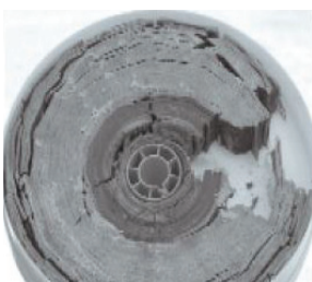
Fig.18 Síndrome del Vinagre en un soporte de Triacetato.
