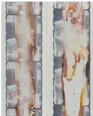
Fig.13 Descomposición Endógena de un soporte de Nitrato.
