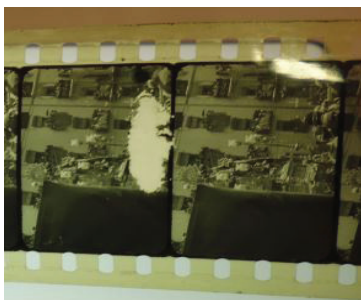
Fig.25 Rollo de Triacetato de la película de Juan Andreu con pérdida de emulsión.
