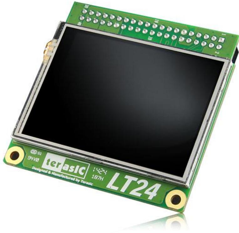
figura 21, Pantalla táctil Terasic LT24
