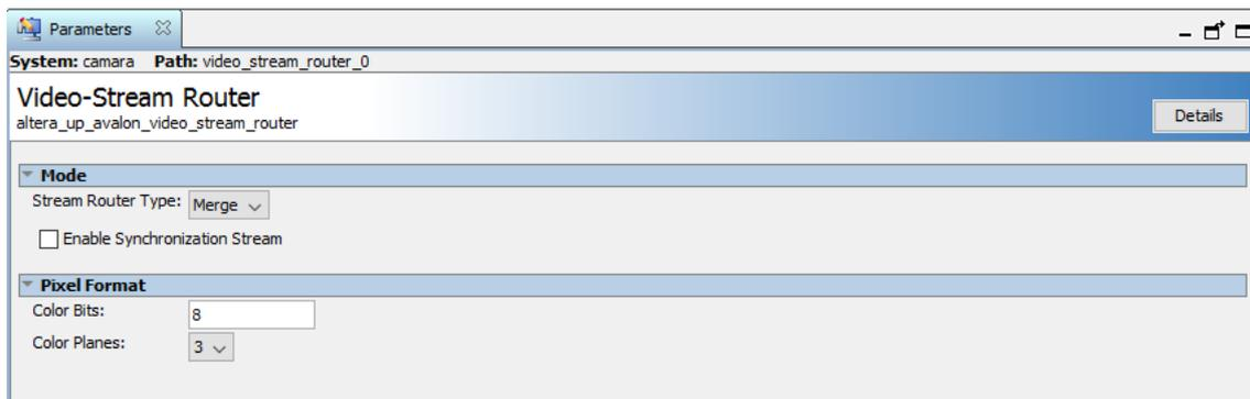
figura 44, Configuración del Video Stream Router
