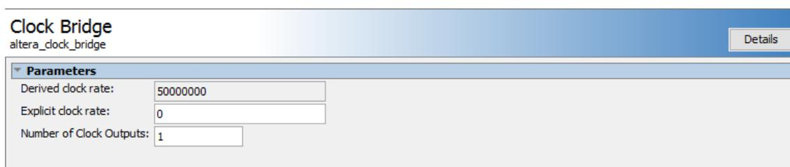
figura 41, Configuración del Clock Bridge para la memoria SDRAM
