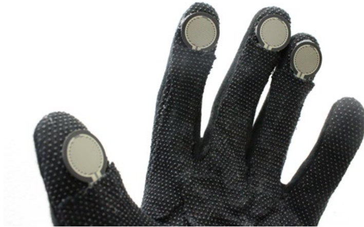
Fig.33 Detalle de los sensores que contiene el guante interactivo
