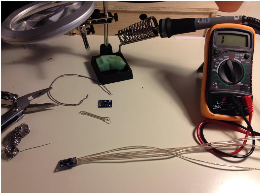
Figura 37: Proceso de soldadura de los cables definitivos con el sensor.
