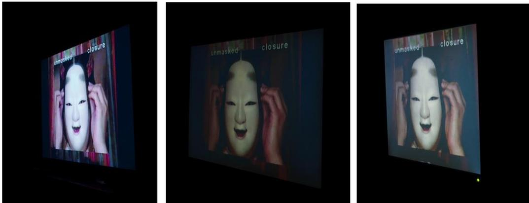
Figura 76, Figura 77, Figura 78 : Izquierda, visión lateral del televisor LED 48" Samsung UE48J5500. Centro, TV LED 22" Televisor Samsung UE22D5003. Derecha, monitor LCD 17" DELL E176FP.
