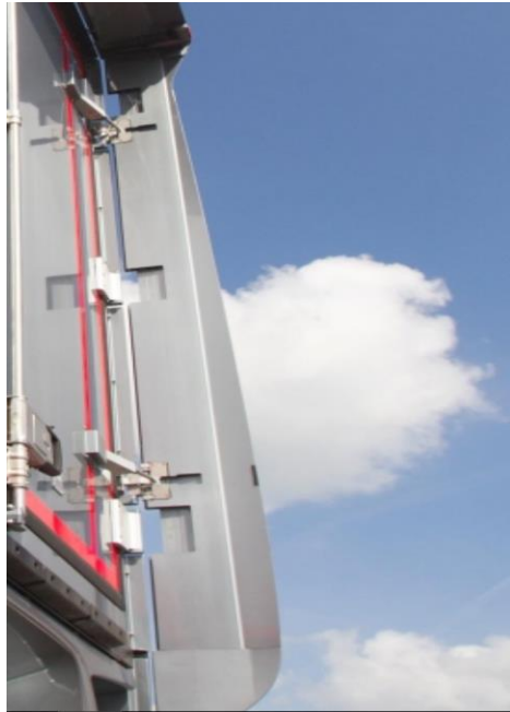
Figura 98. Sujeciones instaladas por Mercedes Benz en deflector lateral. Fuente: Blogspot, Mercedes Benz (© 2012)
