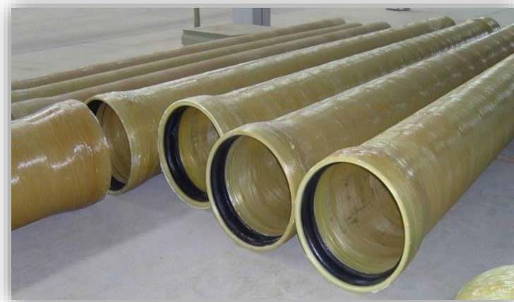
Figura 75. Ejemplo de tuberías realizadas con GFRP.
