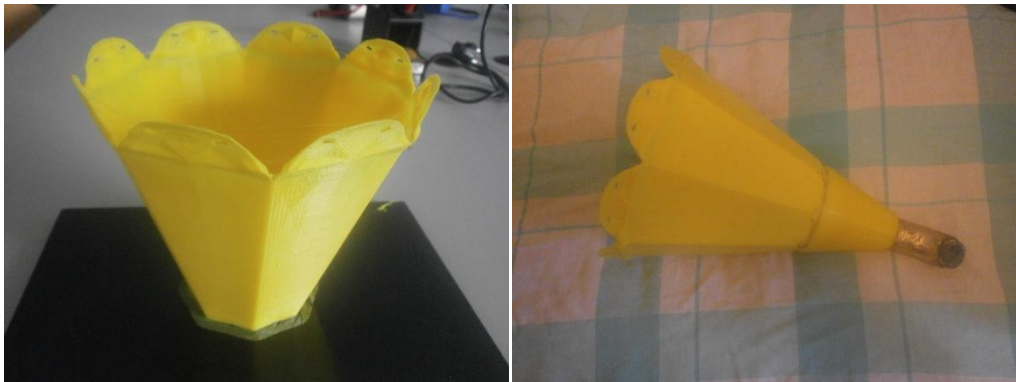
Fig. 46-47. El cuerno, impreso y montado, antes de aplicar el pan de oro.
