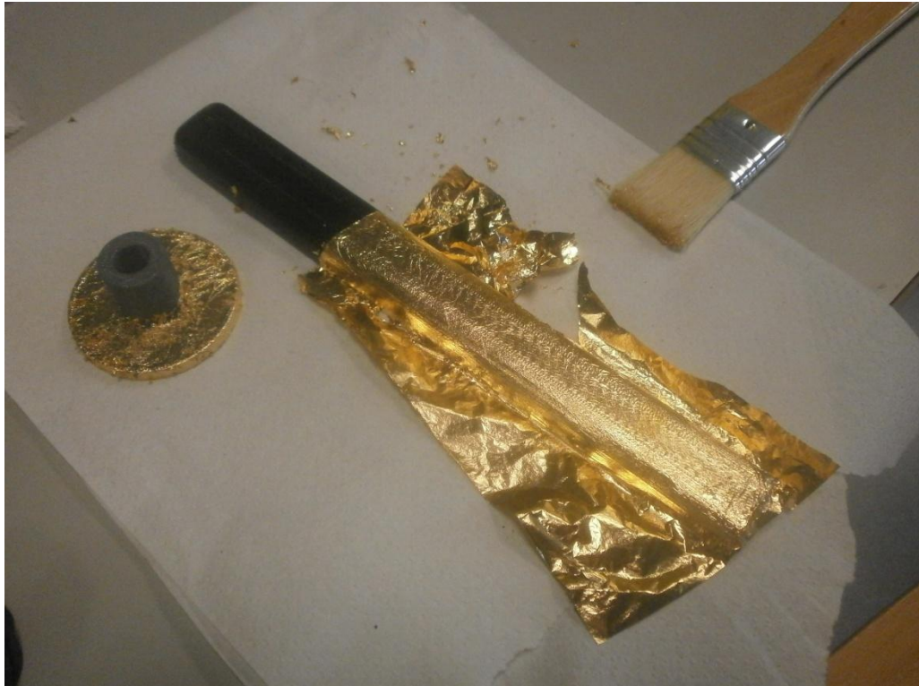
Fig. 48. Proceso de aplicación del pan de oro en la carcasa del brazo lector.
