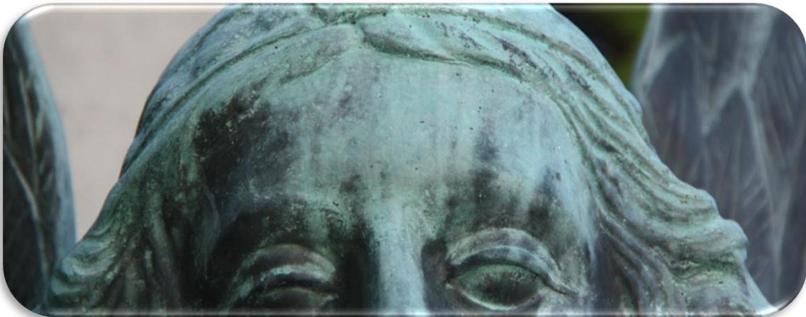
**Imagen 7.** Corrosión por cloruros
