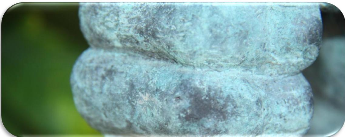
**Imagen 8.** Corrosión por cloruros
