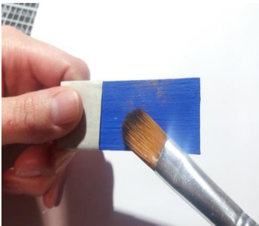
Fig. 8 Ensuciado de las probetas con polvo.
