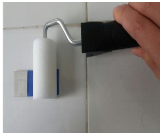
Fig. 9 Ensuciado de probetas con rodillo de esponja.
