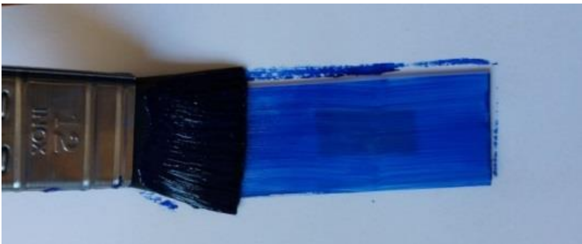
Fig. 5 Segunda capa de pintura de derecha a izquierda.
