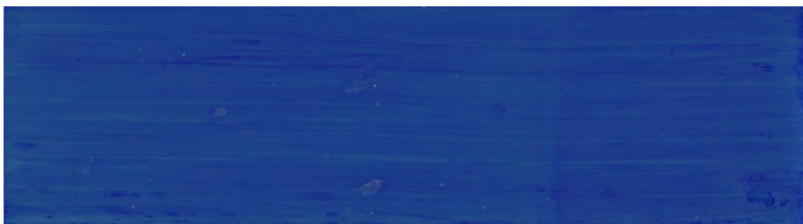
Fig. 21 Probeta de gouache tratada con Groom Stick.
