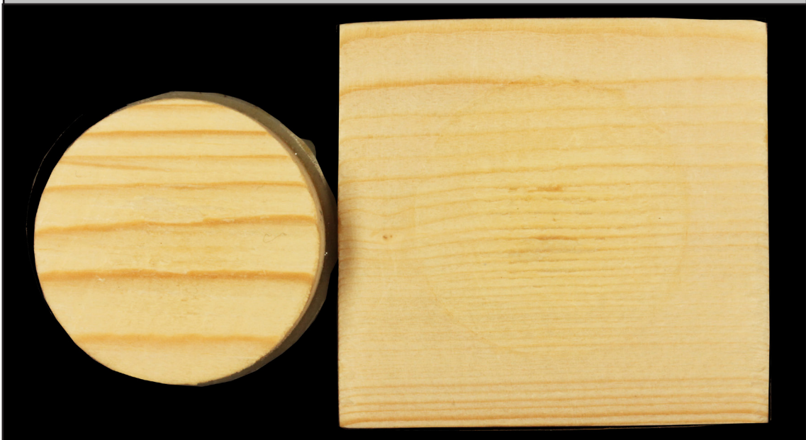
Imagen 206. Detalle de la fuerza ejercida por el adhesivo I.
