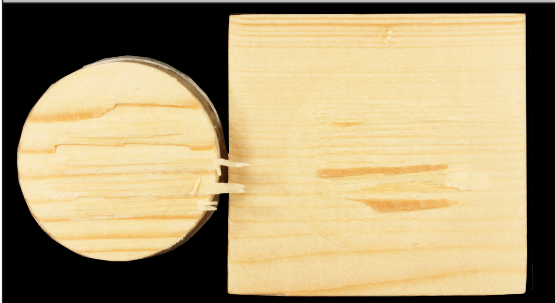
Imagen 204. Detalle de la fuerza ejercida por el adhesivo CP.
