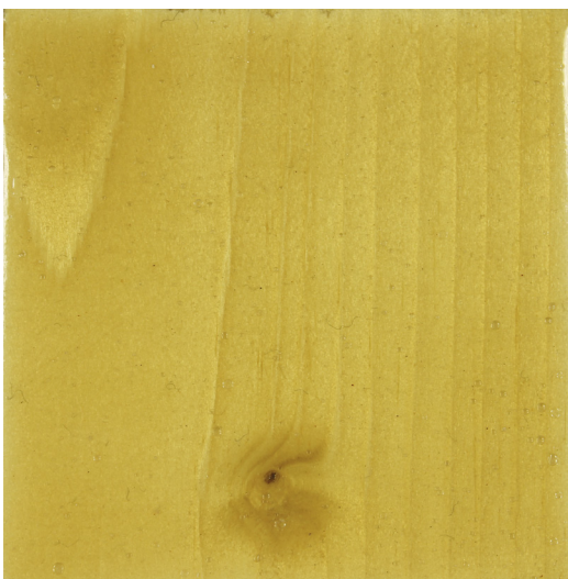
Imagen 157y 158. Aspecto final de la cola fuerte en la cámara de HR
