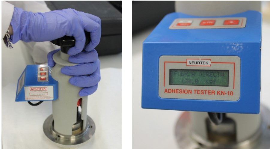
Imagen 54 y 55. A la izq. el Electronic adhesión Tester KN-10. A la dcha. La pantalla digital.
