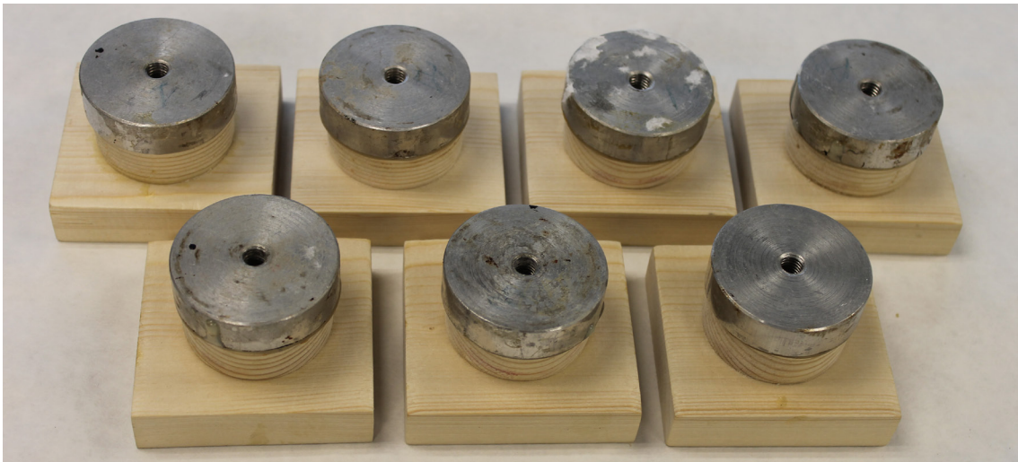
Imagen 70. Pletinas metálicas adheridas a la madera.
