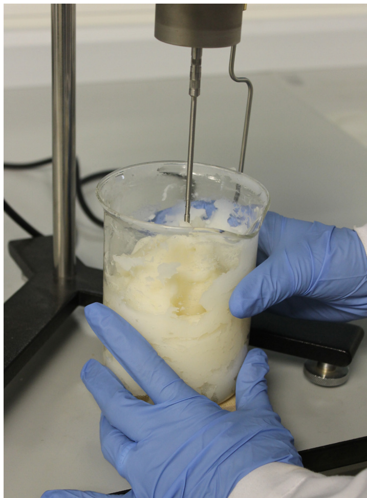
Imagen 73. Medición de la viscosidad del SJN.
