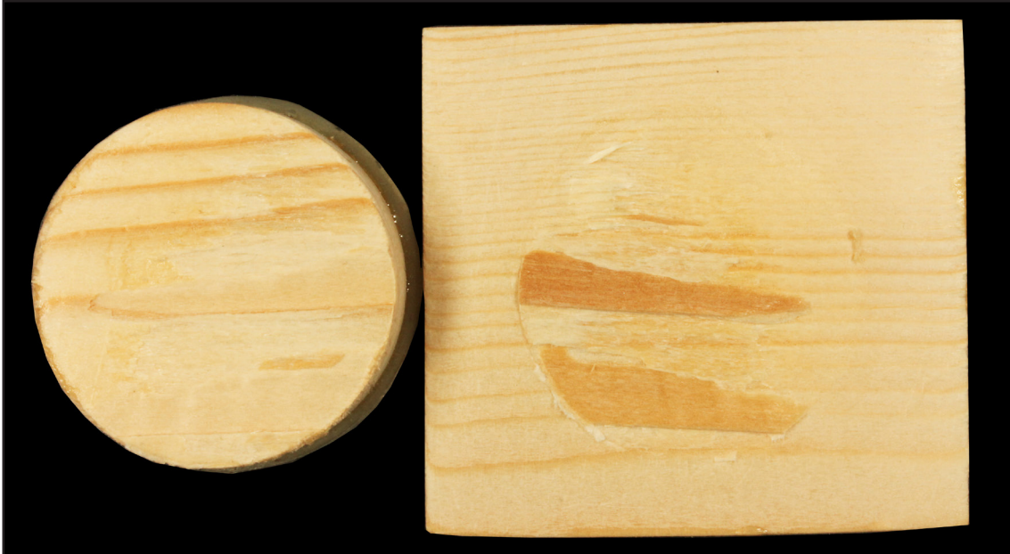
Imagen 203. Detalle de la fuerza ejercida por el adhesivo CPL.
