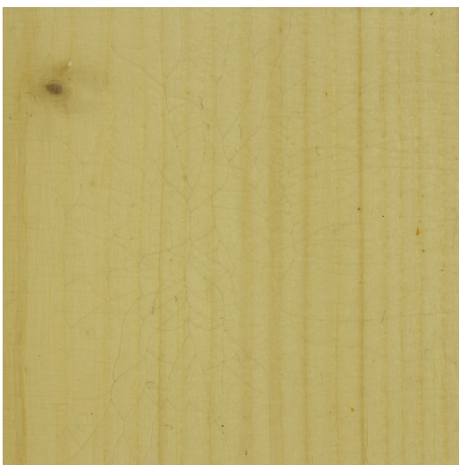
Imagen 169 y 170. Aspecto final de la cola shofu jin nori en la cámara de HR
