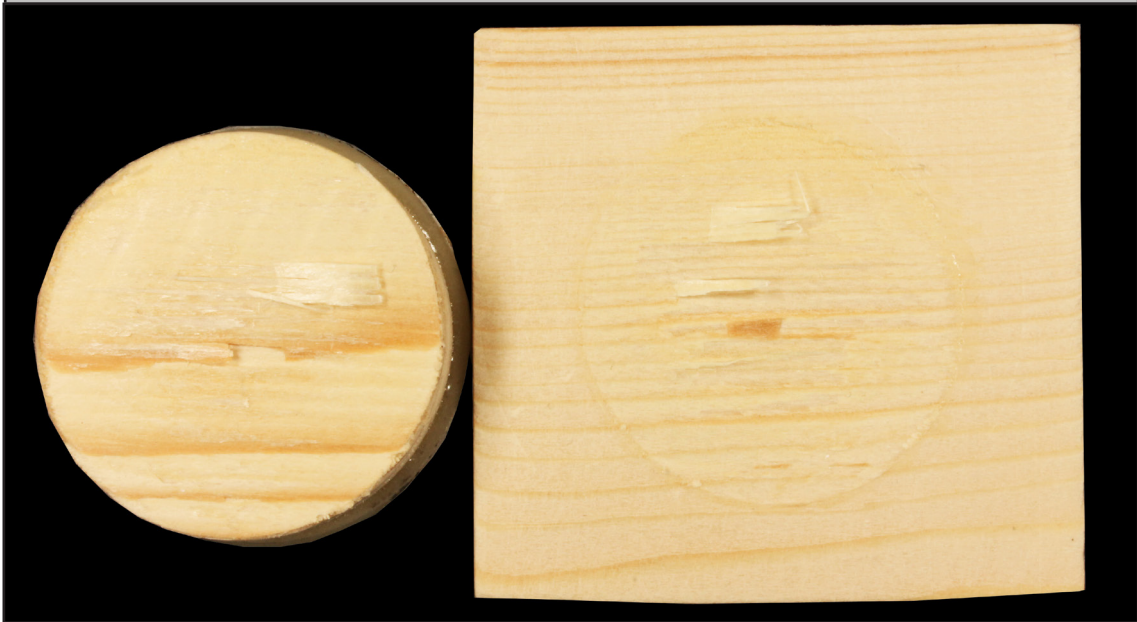
Imagen 205. Detalle de la fuerza ejercida por el adhesivo CG.
