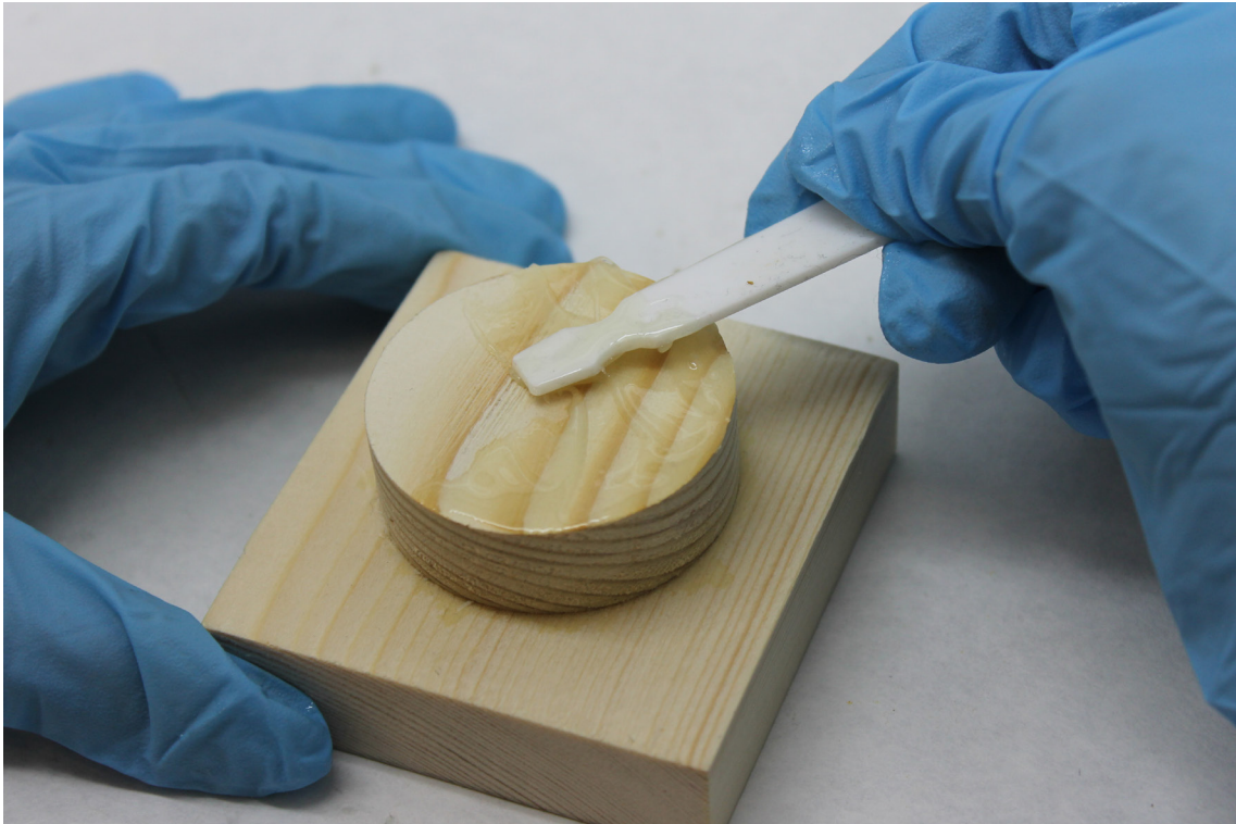
Imagen 69. Aplicación de la resina epoxi.
