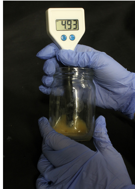
Imagen 78y 79. A la izq. pH de contacto sobre el adhesivo seco. A la dcha. pH sumergido sobre adhesivo líquido.
