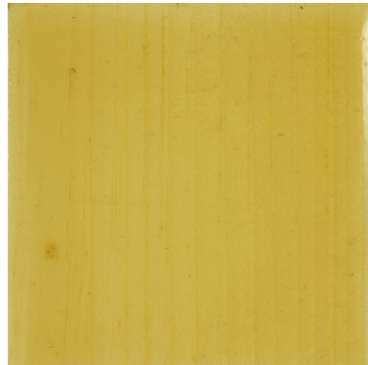
Imagen 84 y 85. A la izq. Aspecto del antes y después de la cola de conejo en placa en la cámara de corrosión.
