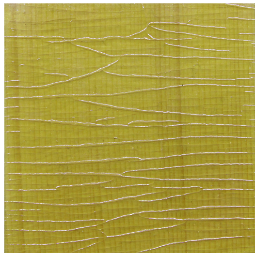
Imagen 166 y 167. Aspecto final de la cola de carpintero en la cámara de T
