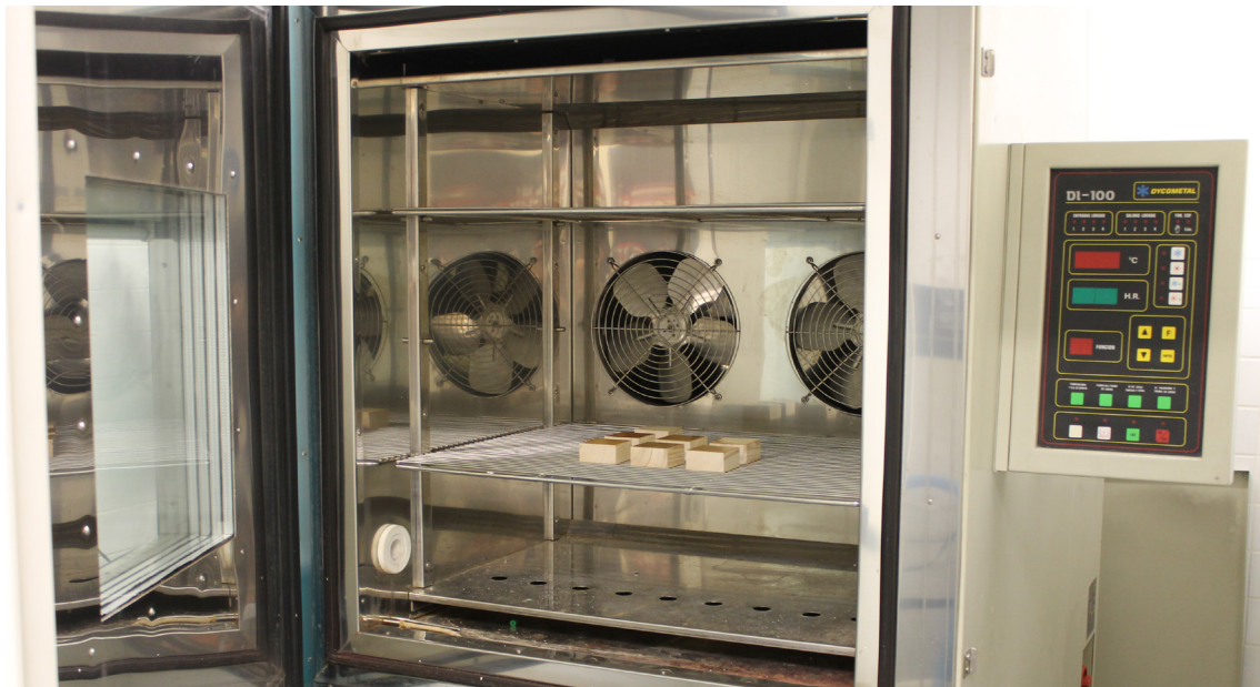
Imagen 66. Probetas en la cámara de humedad y temperatura.
