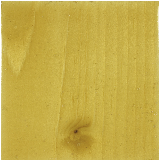
Imagen 160 y 161. Aspecto final de la cola fuerte en la cámara de T
