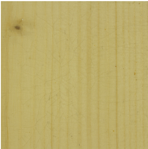
Imagen 172 y 173. Aspecto final de la cola shofu jin nori en la cámara de T
