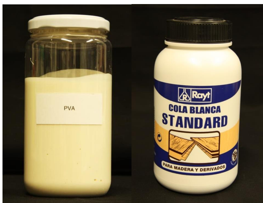
Fig. 20 y 21. Acetato de polivinilo y su envase comercial de la casa Rayt
