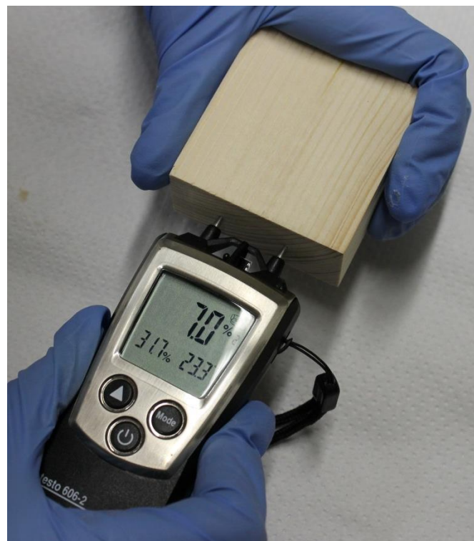
Fig.65. Medición de la HR de la madera mediante xilohigrómetro
