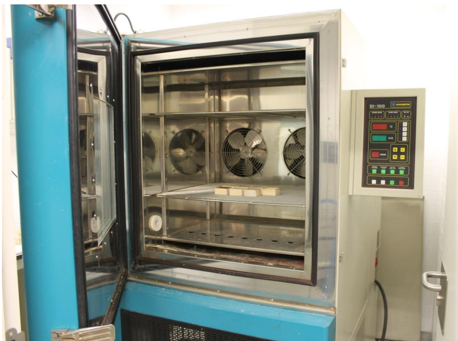
Fig.69. Probetas dentro de la cámara de T a y HR
