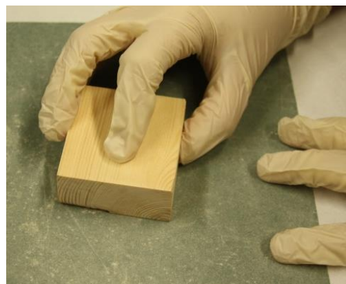
Fig.37. Lijado de probetas
