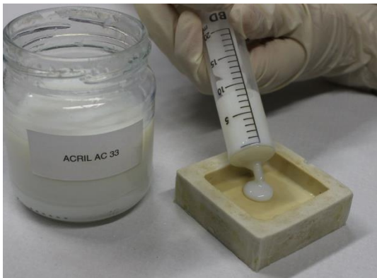
Fig.41. Aplicación Acril 33 en molde de silicona para las probetas de flexibilidad
