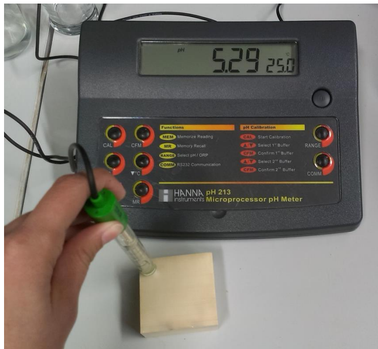
Fig.64. Medición de pH mediante pH-metro de contacto
