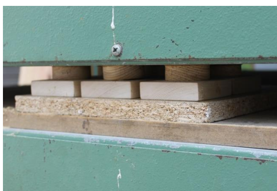
Fig.45. Prensado de las probetas
