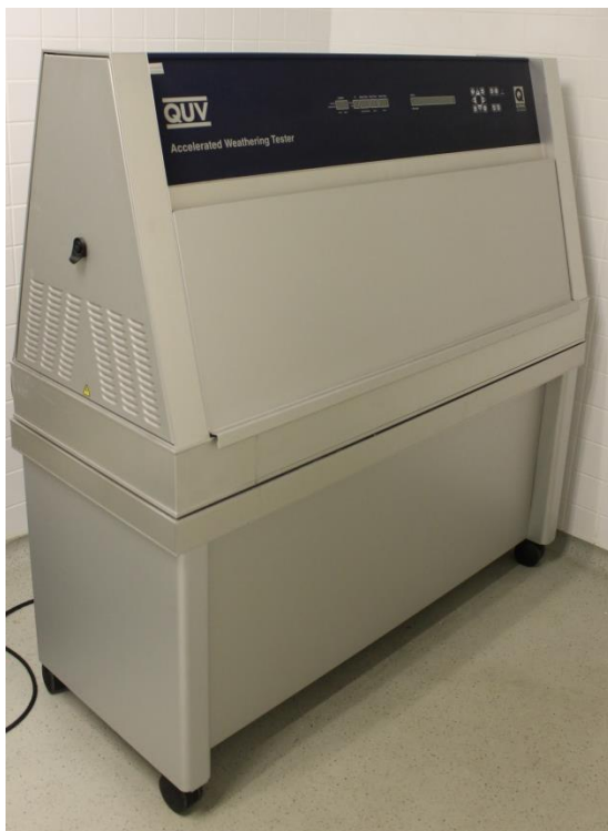
Fig.67. Cámara de radiación ultravioleta
