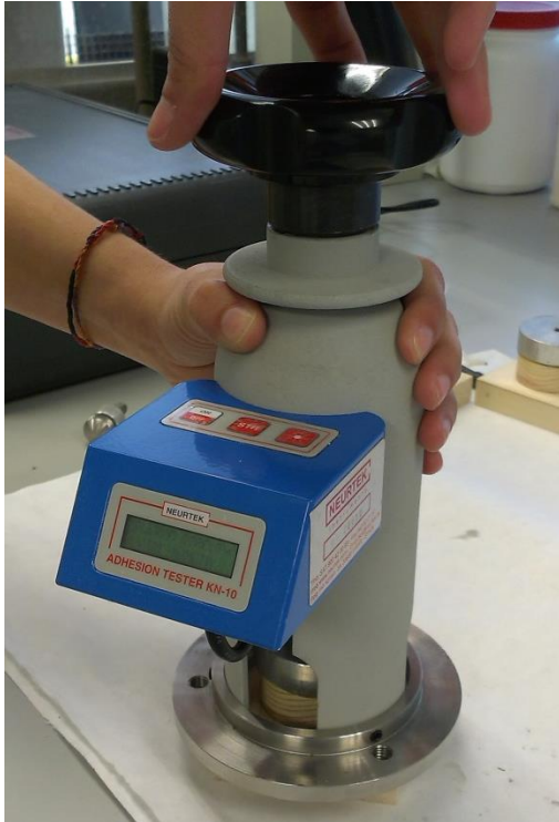
Fig.55. Máquina de tracción Neurtek KN-10 Fig.56. Sufridera metálica de Ø50mm y Araldite Standart
