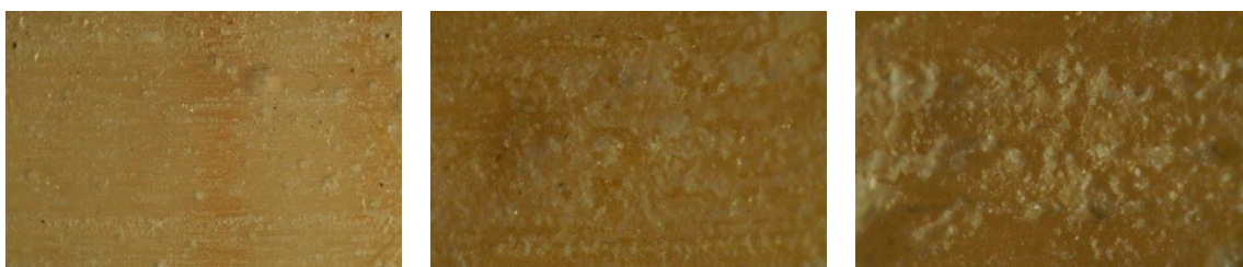
Fig.72 Microfotografías de la probeta EPO/A, 80x, sometida a 10-30-60 ciclos/min de abrasión
