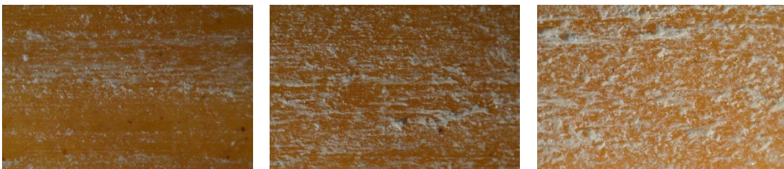
Fig.80 Microfotografías de la probeta TIT/A, 20x, sometida a 10-20-30 ciclos/min de abrasión
