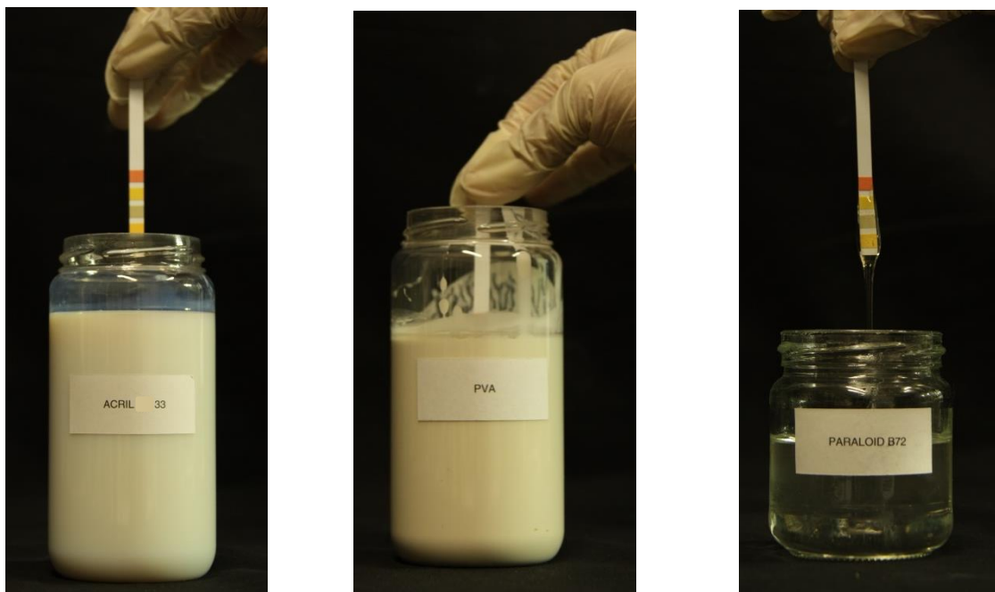
Fig.61-63 .Mediciones de pH mediante tiras de papel en diferentes adhesivos
