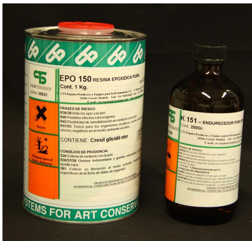
Fig.24 Resina EPO-150 y endurecedor K-151
