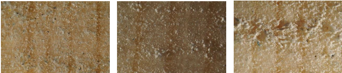
Fig.74 Microfotografías de la probeta AC/A, 20x, sometida a 10-20-30 ciclos/min de abrasión
