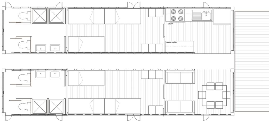
Fig. 33 Plano de los contenedores (2 unidades de 42 pies) habitables para instalar en el ATM.
